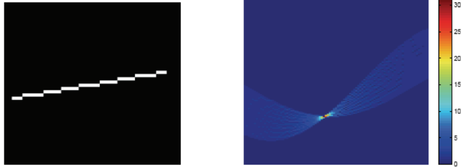
Figur 3-10: Eksempel på resultatet av linjen (venstre) transformert med normalparametriseringen til parameterplanet (høyre) [8].
