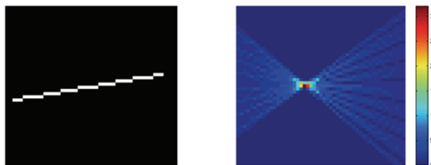
Figur 3-8 En linje i bildeplanet (venstre) og transformasjonen i parameterplanet (høyre)[8].
