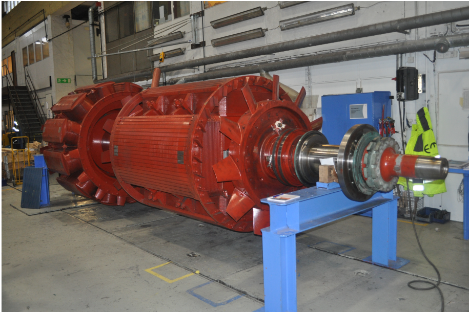
Fig. 7.6: Oversiktsbilde av rotor type Q48/Q49. Foto: Privat
