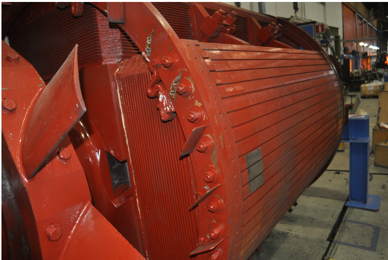
Fig. 4.1: Kortslutningsringen ligger slik at strømmen gjennom den vil kunne indusere strømmer i feltviklingen
