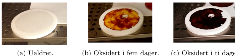
Figur 10: Oksidering av HDPE: Materialet endrer tydelig farge etter kun få dager.
