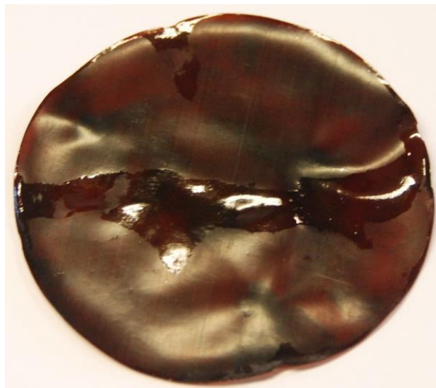
Figur 4 - 4: Bildet av objekt oksidert 720 timer. En ujevn overflate observeres.
