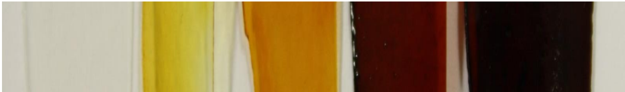
Figur 4 - 3: Ulike oksideringsgrader av PE og PEX studert gjennom et mikroskop. Fra venstre: referanseobjektet (0 timer oksidasjon), kategori 1 (18 timer oksidasjon), kategori 2 (72 timer oksidasjon) og de to siste er ukjent kategori (340 timer og 720 timer oksidasjon).
