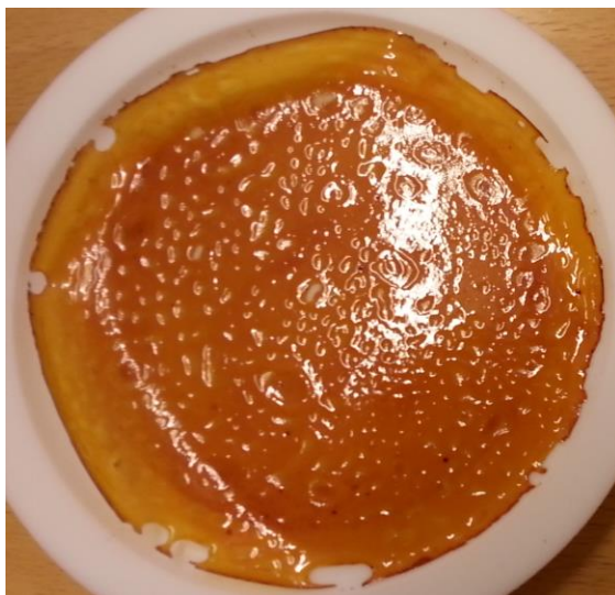
Figur 4 - 1: Deformerte PE-objekter oksidert 18 timer. Formen endres ved at kantene blir ujevne og det dannes hull i objektet. Ser at oksidasjonen er sterkest ved ytterkantene på objektet.
