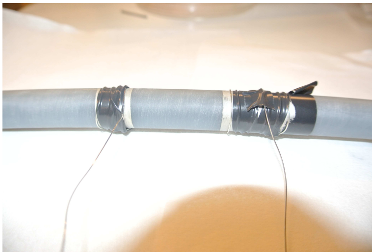
Figur 3.15: Påmalte måleelektroder for måling av overflatekonduktivitet
