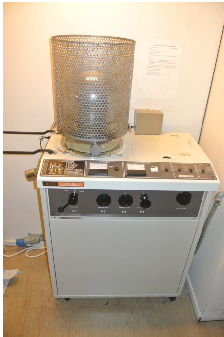
Figur 3.3: Pådampingsmaskin klargjort for pådamping av elektroder
