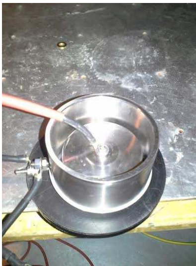
Figur 4.4: Polymer-disk oppkoblet med elektroder for dielektriske målinger
