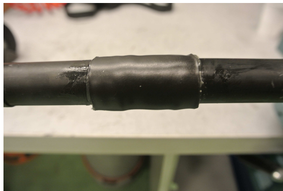
Figur 3.9: Guard med krympestrømpe
