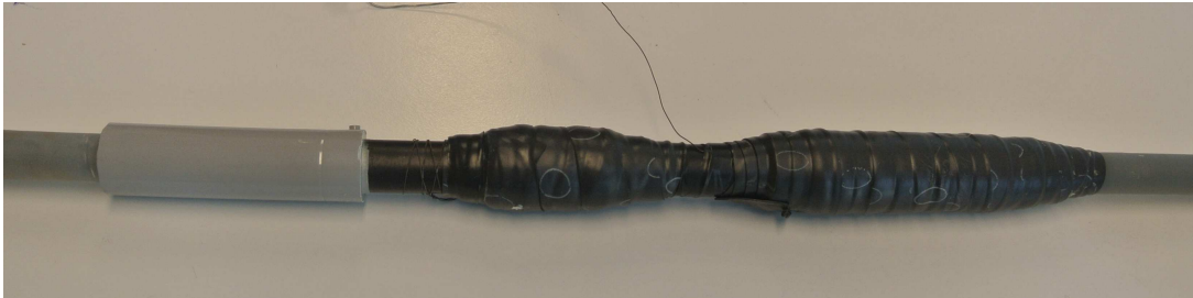
Figur 3.14: Prøveobjekt med innstøpning, guard og feltstyrt ende
