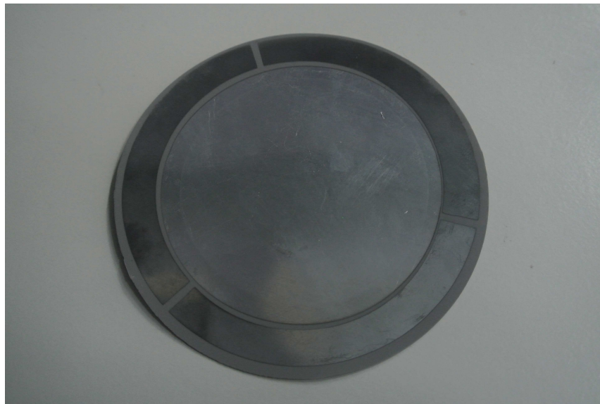
Figur 3.5: Polymerdisk med pådampede elektroder
