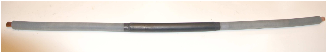
Figur 3.7: Strippet kabel med påmalt konduktiv lakk
