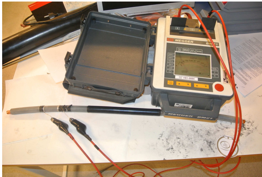
Figur 4.8: Oppsett med Megger BM21 for måling av overflatekonduktivitet
