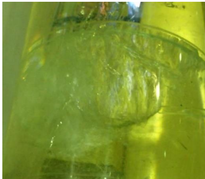
Figur 4-16 Erosjon av luftboble ståande ved ruheitsselement i sjakt.
