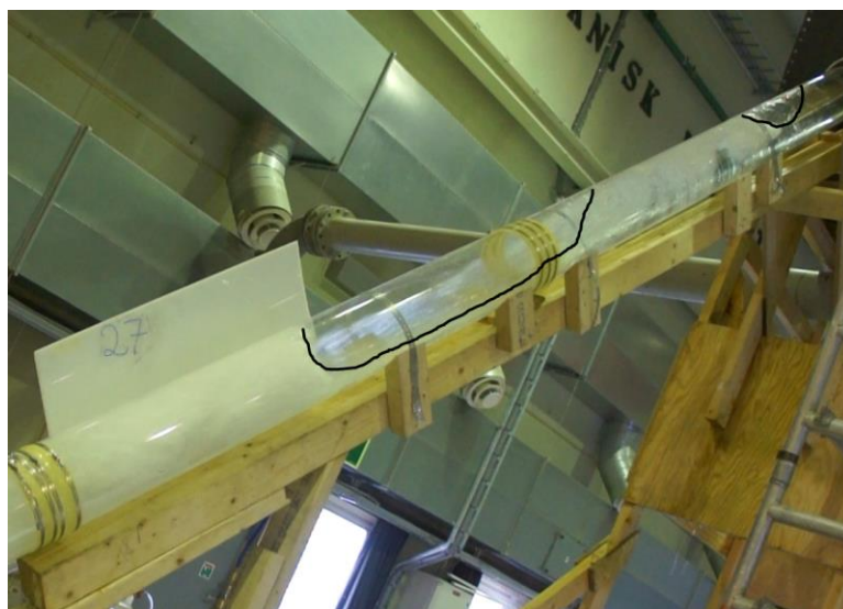
Figur 4-8 Stående luftlomme for F = 0.9 ved D = 172 mm.
