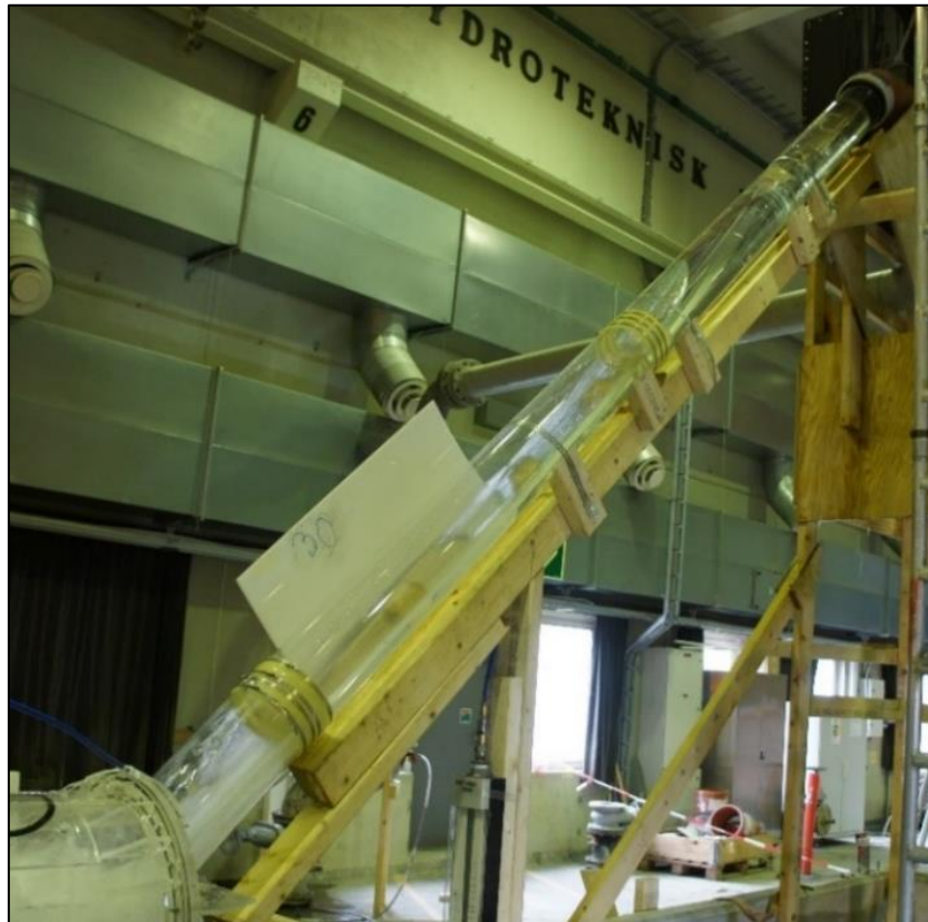
Figur 4-15 Lagdelt strøyming for F = 1.0 ved D = 172 . Den ståande luftputa strekk seg frå tunnel og over det andre gule bandet som knyt saman sjaktdelane.
