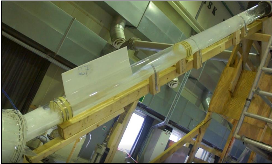
Figur 4-14 Støytvis strøyming for F = 0.9 ved D = 172 mm. Ei luftboble er på veg ut av sjakta, medan ei ny er på veg oppover frå nedre del av sjakta.
