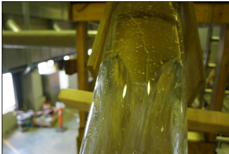
Figur 4-7 Stopp i retur av luft for F = 0.9 ved D = 172 mm med auka ruheit. Biletet viser situasjonen frå oversida av sjakta.
