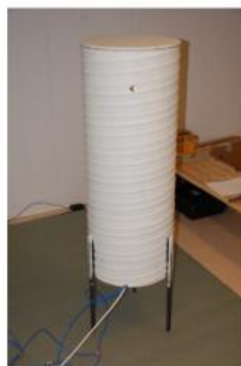
Figur 17 Spirorør for simulering av menneske
