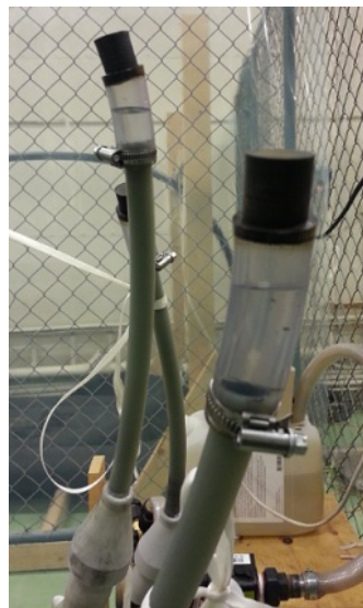
(b) Plastrør montert med rørklemmer hvor en enkelt kan følge med på vannivået i lederkanalen
