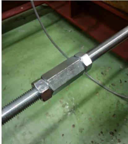
(b) Fast mutter på staget til justering av strekket
