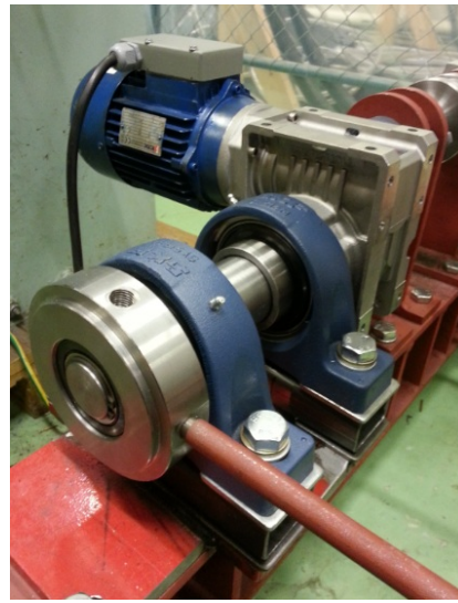
(b) 1,0 Hz motor med aksling og drivhjul
