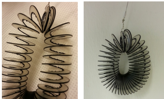
Figur 3.16: Spiralisert isolasjon klar til innfarging
