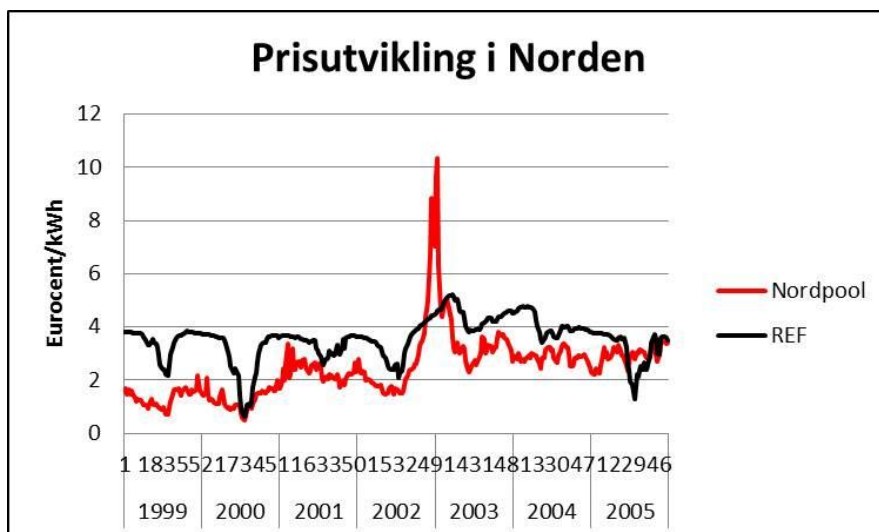
Figur 5.1-8 Utvikling av systemprisen for Norden frå Nordpool [40] og kraftprisen for Norden i referansecasen.
