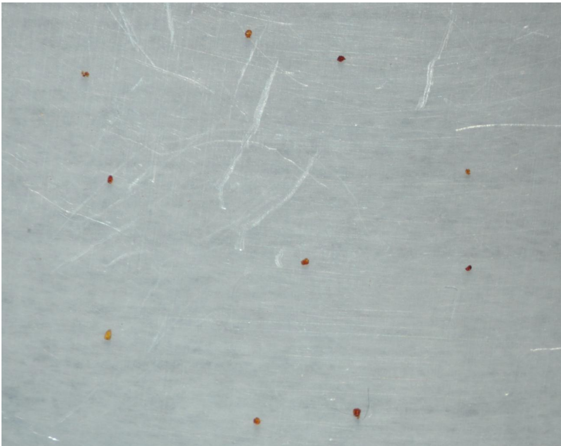
Figur 9-1: Plassering av partikler på overflaten av PE-platen.
