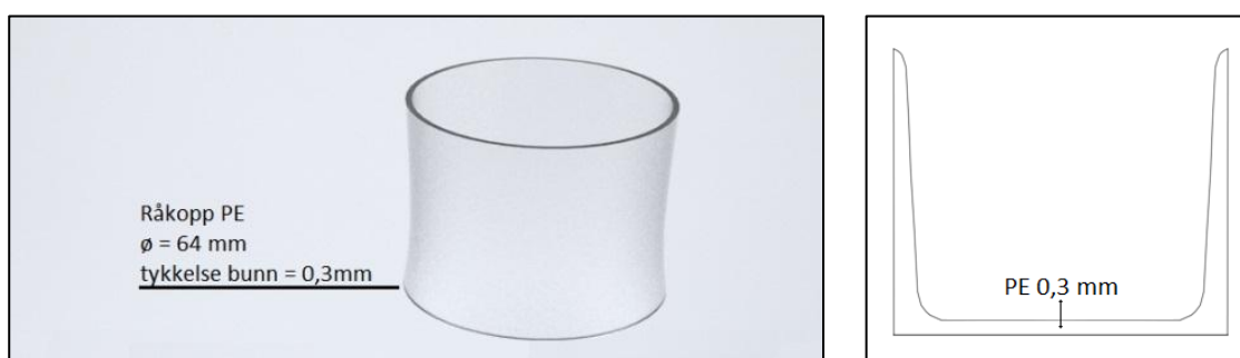
Figur 3-2: Venstre: skisse av råkopp, Høyre: snitt gjennom råkopp.
