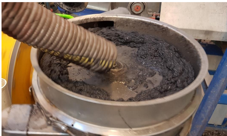
Figur 6-3: Bilde av swecosikt under forsøkskjøring. Massen presses ut i kantene av rotasjonsvibrasjonen og materialet bygges opp i kantene til det går ut i returrøret.
