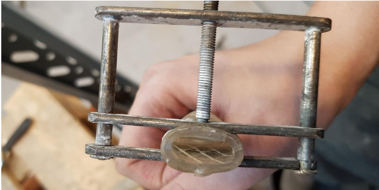
Figur 7-2: Slange som ble brukt til re-pulping. Den ble sammenklemt for å få trykk og spre vannet mer utover for å dispergere partikler fra hverandre. Ble koblet på i punkt (B) i figur 7-1.
