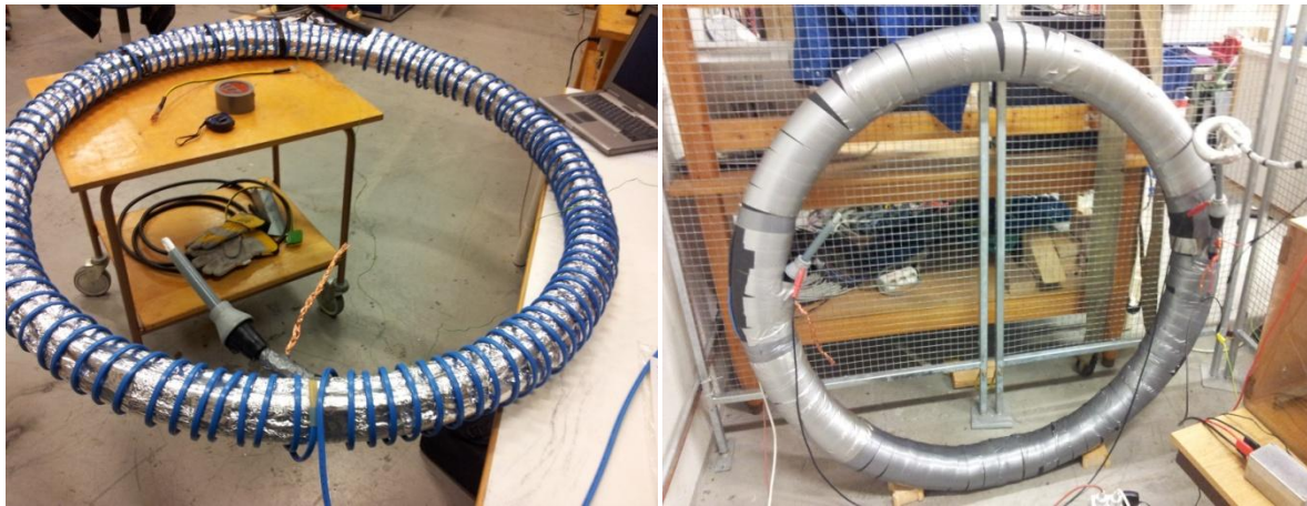
Figur 3.5a) Prøveobjektet med varmekabel b) Prøveobjektet med skumgummiisolasjon
