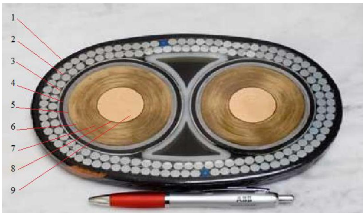
Figur 2.1, NorNed kabelen avkuttet [4]
