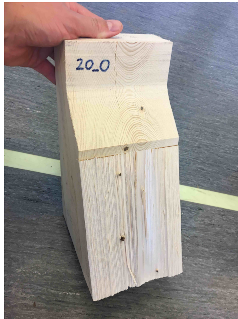
Figur A.55: Bruddplan for prøvestykke 20-0
