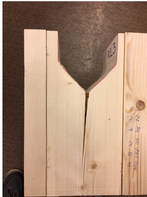
Figur A.75: Bruddplan for prøvestykke R0-3
