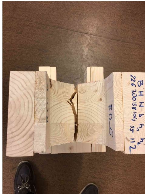
Figur A.80: Bruddplan for prøvestykke R0-6
