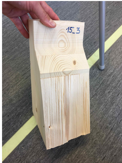
Figur A.45: Bruddplan for prøvestykke 15-3
