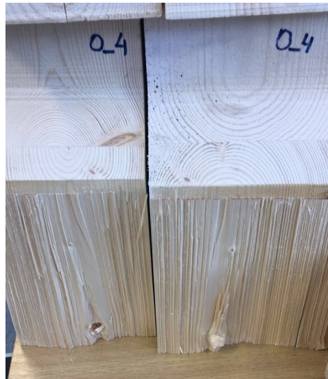
Figur A.5: Bruddplan for prøvestykke 0-4
