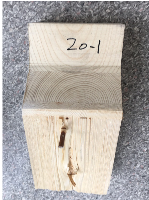
Figur A.57: Bruddplan for prøvestykke 20-1
