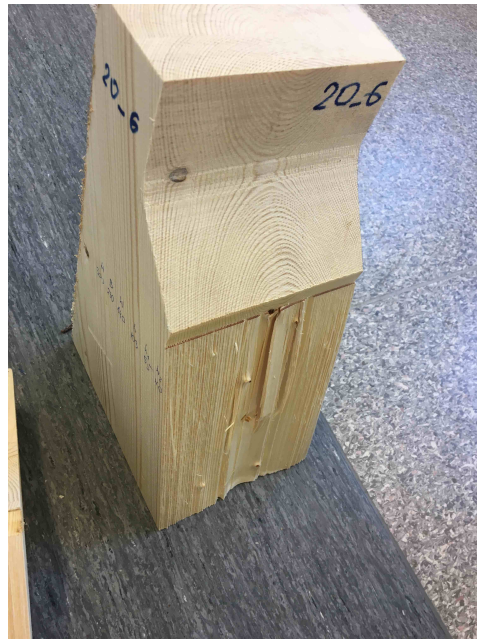
Figur A.67: Bruddplan for prøvestykke 20-6
