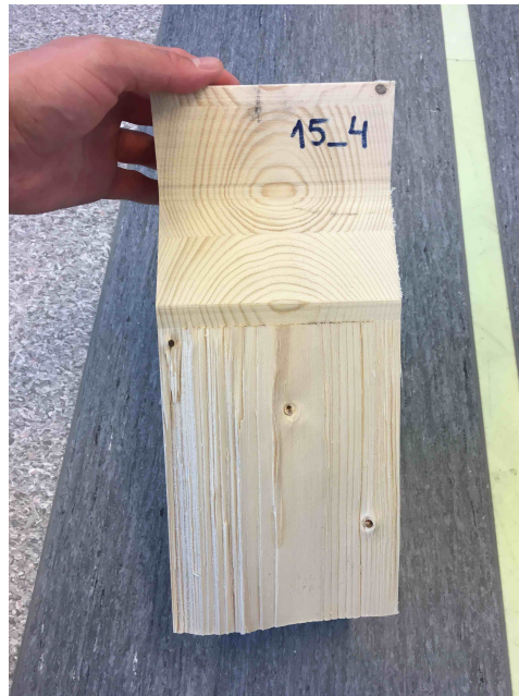
Figur A.47: Bruddplan for prøvestykke 15-4
