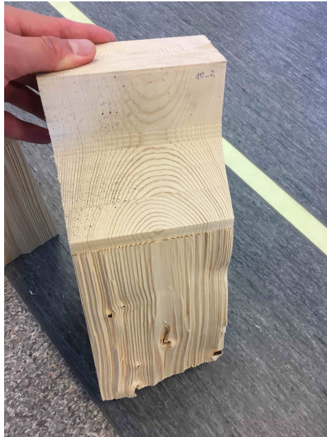
Figur A.33: Bruddplan for prøvestykke 10-2
