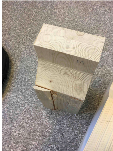
Figur A.15: Bruddplan for prøvestykke 5-1
