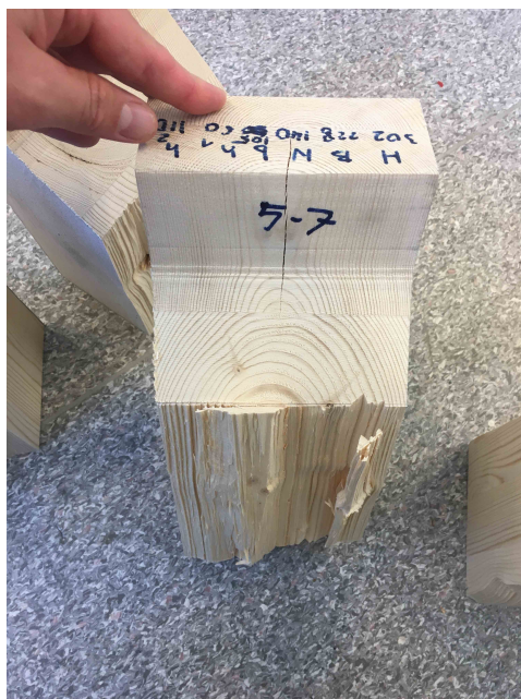
Figur A.27: Bruddplan for prøvestykke 5-7
