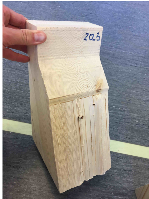
Figur A.61: Bruddplan for prøvestykke 20-3
