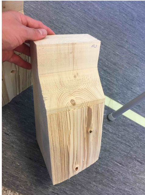
Figur A.41: Bruddplan for prøvestykke 10-7
