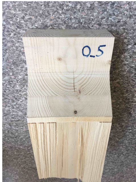
Figur A.7: Bruddplan for prøvestykke 0-5
