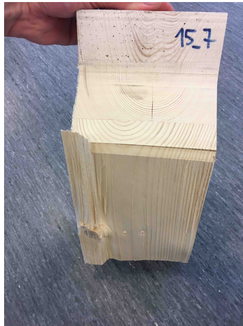
Figur A.53: Bruddplan for prøvestykke 15-7
