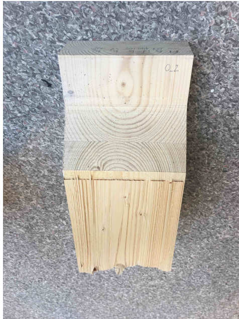
Figur A.1: Brudd på prøvestykke 0-2
