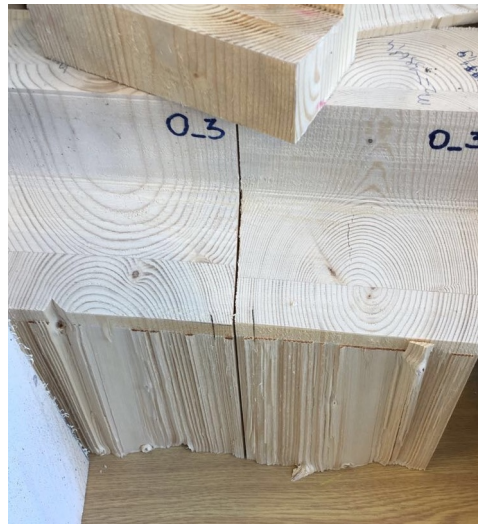
Figur A.3: Brudd på prøvestykke 0-3
