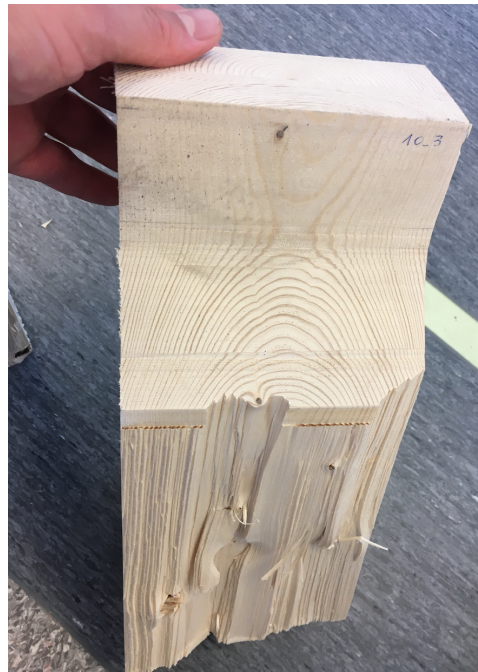
Figur A.35: Bruddplan for prøvestykke 10-3
