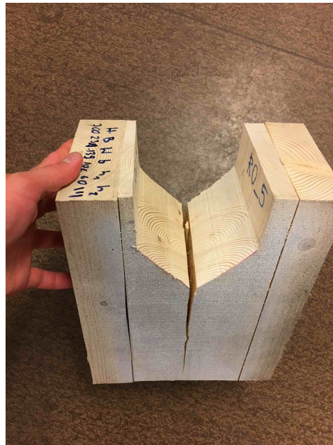
Figur A.78: Bruddplan for prøvestykke R0-5
