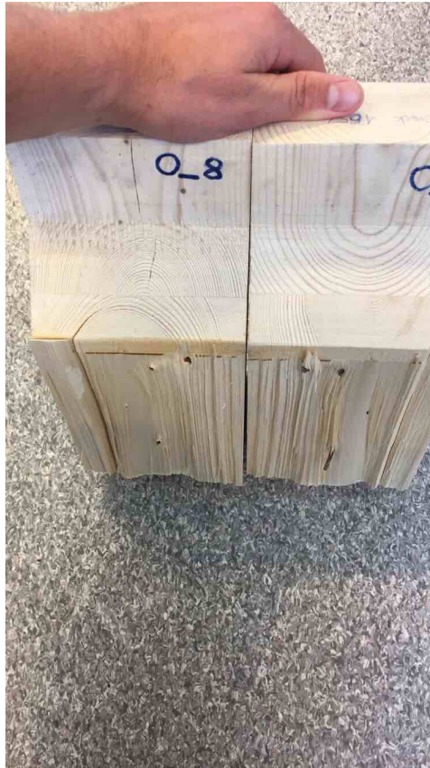
Figur A.13: Bruddplan for prøvestykke 0-8
