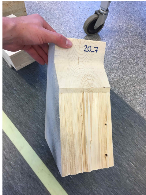
Figur A.69: Bruddplan for prøvestykke 20-7
