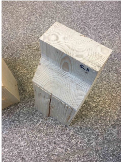
Figur A.19: Bruddplan for prøvestykke 5-3
