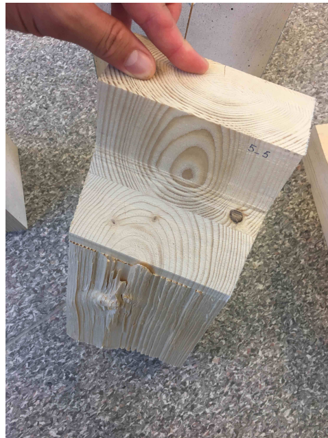
Figur A.23: Bruddplan for prøvestykke 5-5
