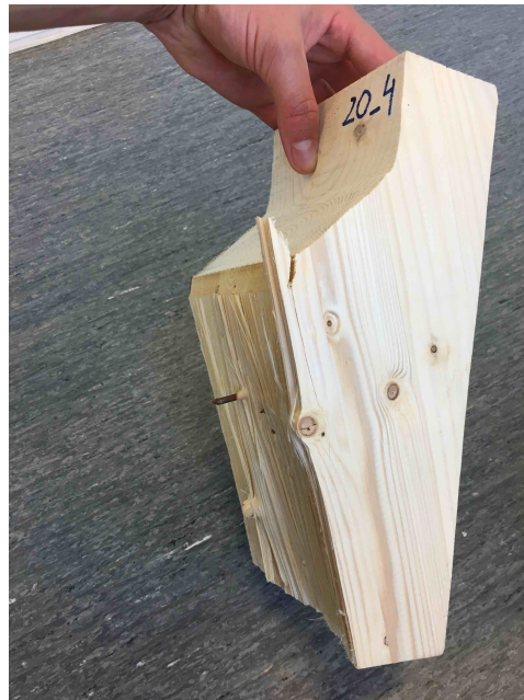
Figur A.63: Bruddplan for prøvestykke 20-4
