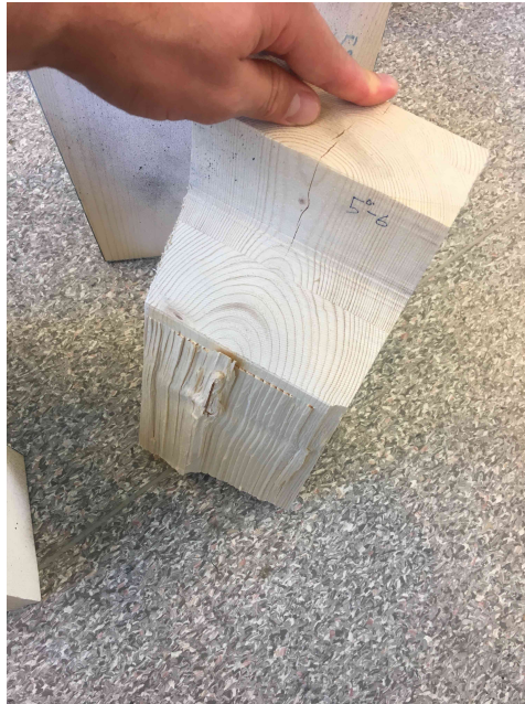
Figur A.25: Bruddplan for prøvestykke 5-6
