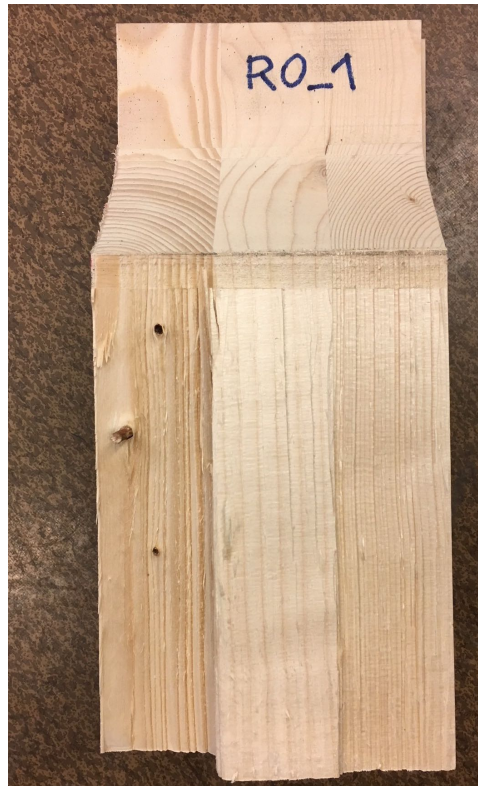
Figur A.71: Bruddplan for prøvestykke R0-1
