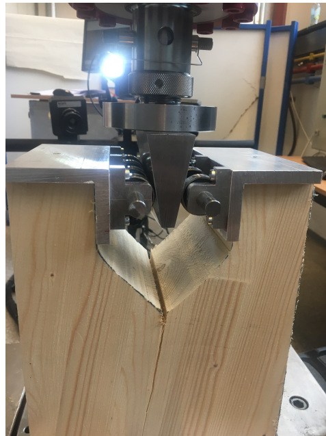
Figur 3.3: Lastcelle av aluminiumsbraketter med stålhjul med rullelager
