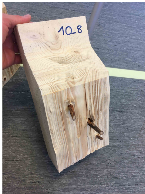
Figur A.43: Bruddplan for prøvestykke 10-8
