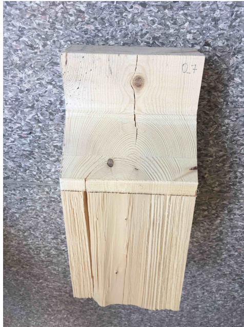
Figur A.11: Bruddplan for prøvestykke 0-7
