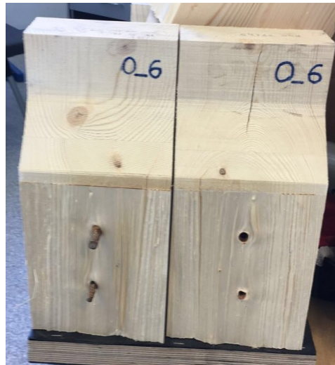
Figur A.9: Bruddplan for prøvestykke 0-6
