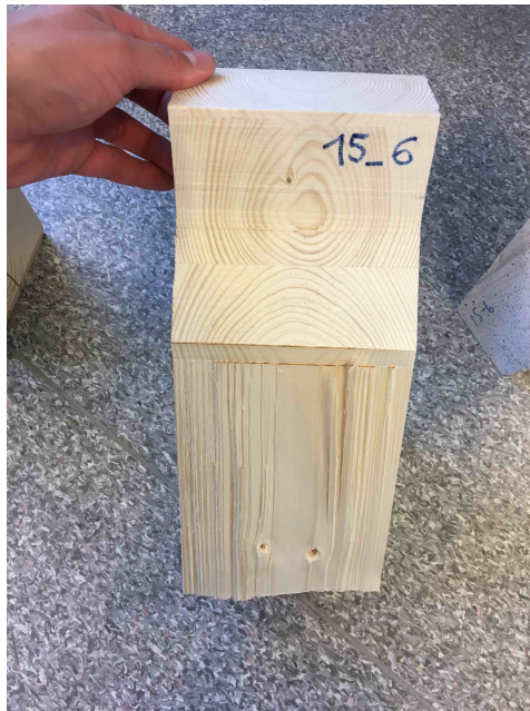
Figur A.51: Bruddplan for prøvestykke 15-6
