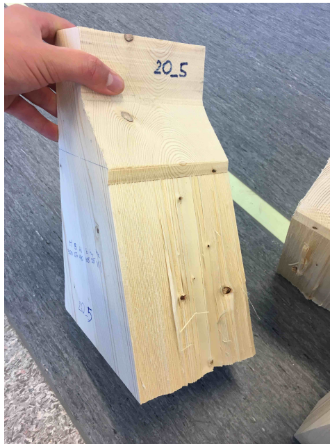
Figur A.65: Bruddplan for prøvestykke 20-5
