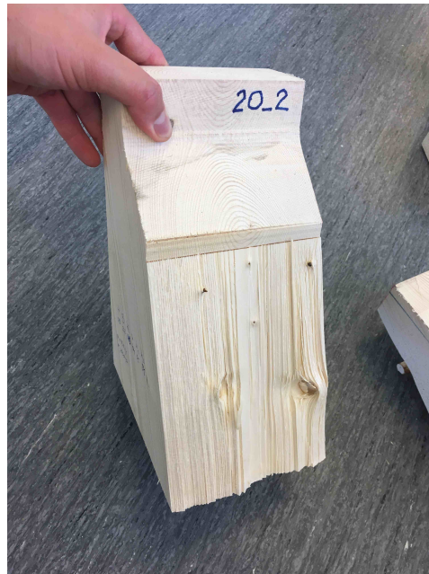
Figur A.59: Bruddplan for prøvestykke 20-2
