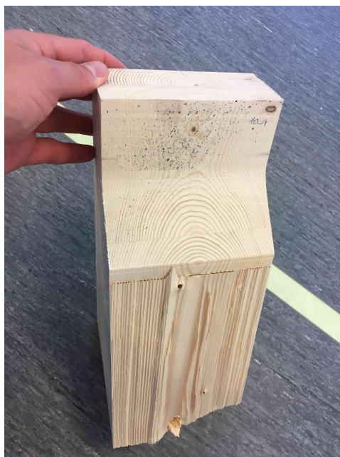
Figur A.37: Bruddplan for prøvestykke 10-4
