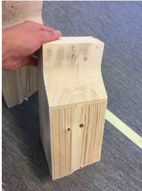
Figur A.39: Bruddplan for prøvestykke 10-5
