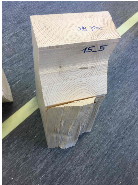
Figur A.49: Bruddplan for prøvestykke 15-5
