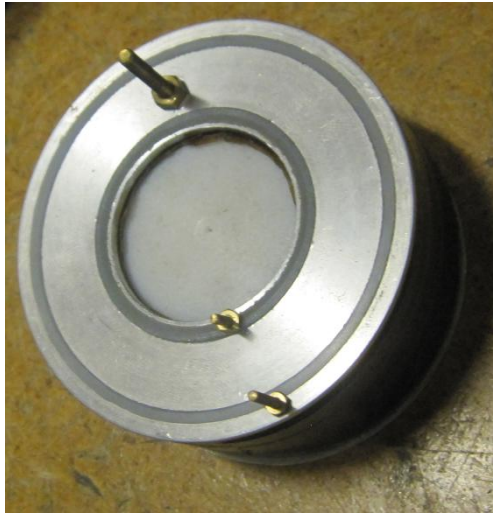
Figur 3-9, Måleelektrode for måling av langsgående polarisasjon.
