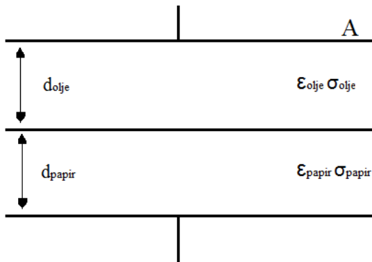
Figur 2-8, Forenklet lagvis isolasjonssystem.
