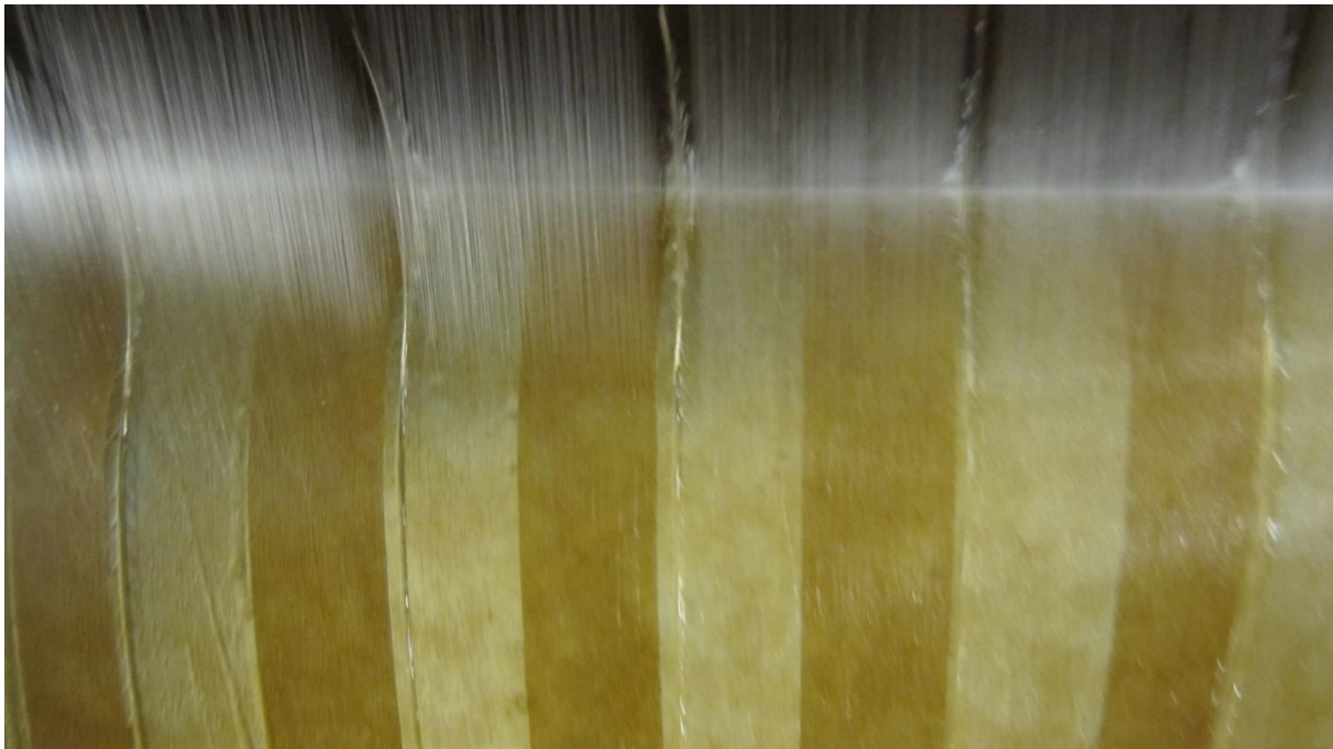
Figur 4-24, Avrulling av isolasjonslag.
