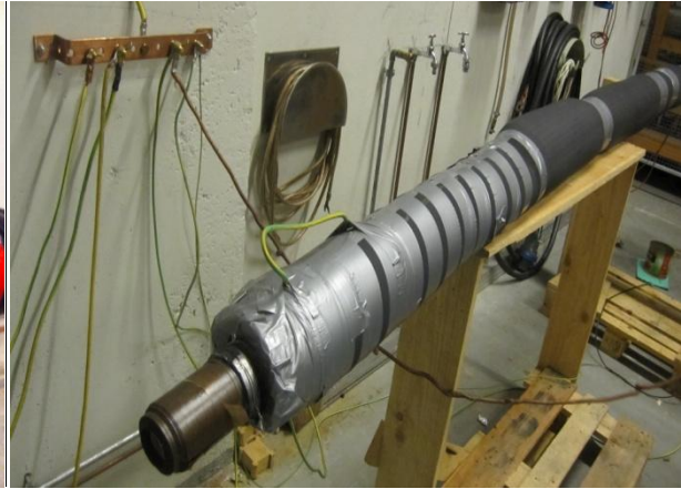
Figur 3-5, Prøveobjekt med isolasjon pålagt
