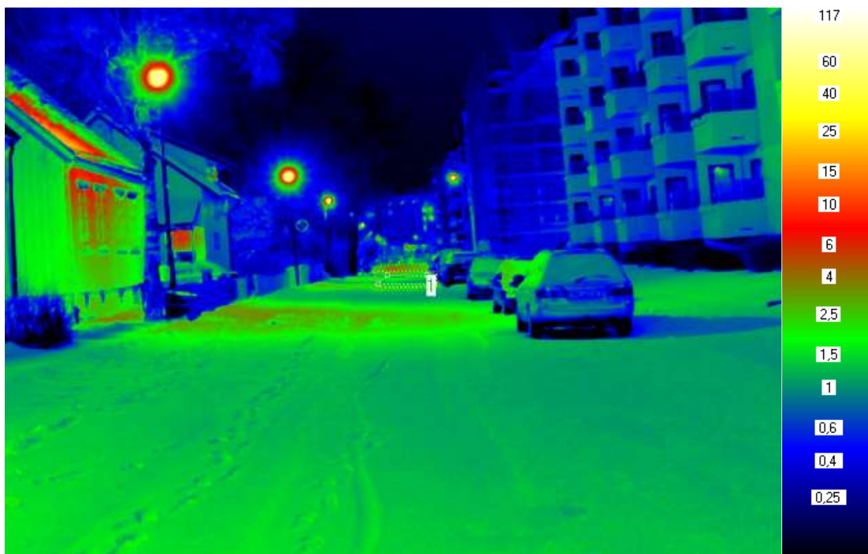
Figur 7.23: Luminansbilde generert av LMK2000, Udbyes gate med snødekke
