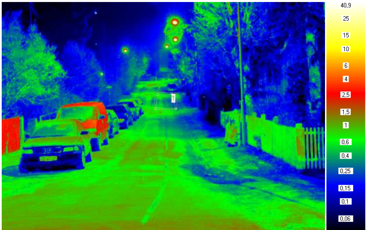
Figur 7.9: Luminansberegningsbilde generert av LMK2000, Wedelsgate med tørr veibane
