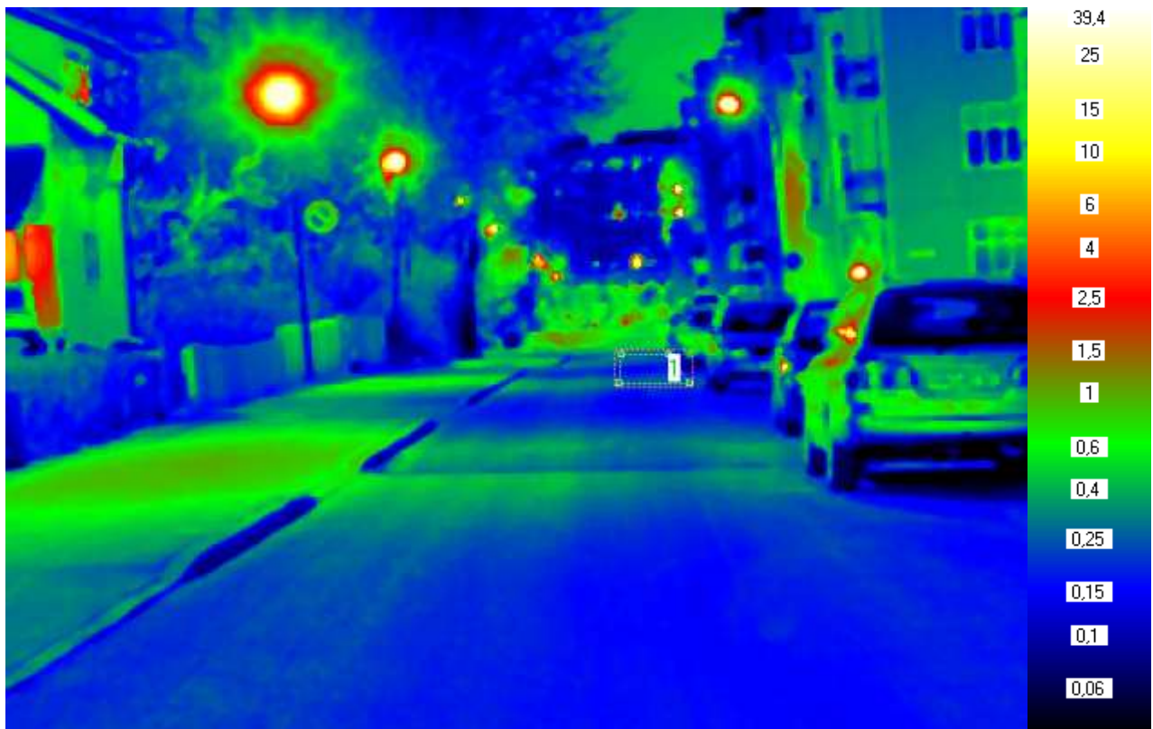
Figur 7.25: Luminansbilde generert av LMK2000, Udbyes gate med tørr veibane
