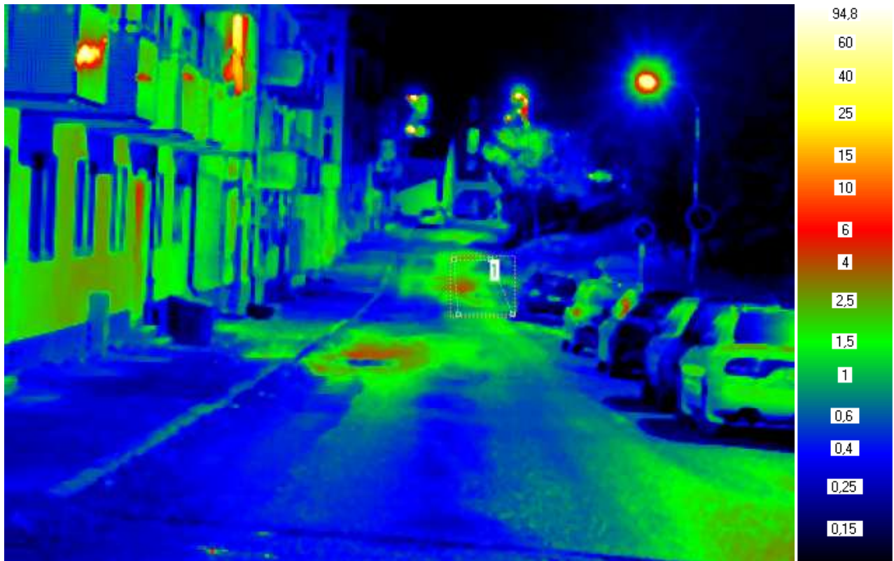
Figur 7.16: Luminansbilde generert av LMK2000, Klæbuveien med våt veibane
