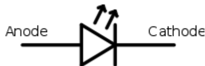
Figur 2.1 Elektrisk symbol for lysdiode
