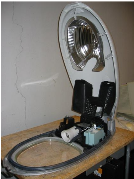
Figur 3.8 Philips Iridium, lokk åpent
