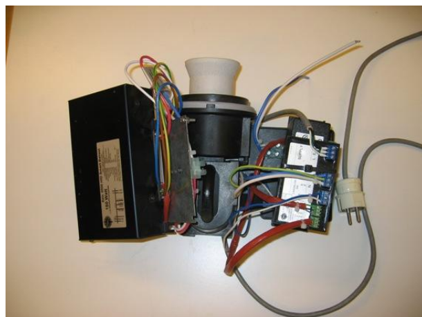
Figur 3.12 Selc 2000 HID elektronisk forkobling
