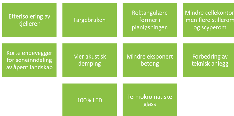
Figur 29. Bygningsmessige endringer i Powerhouse Kjørbo fra første byggetrinn til de tre siste blokkene.
