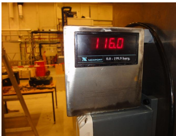
Figur A-13 Digital trykkmåler for nøyaktig avlesning av trykk under trykktesting
