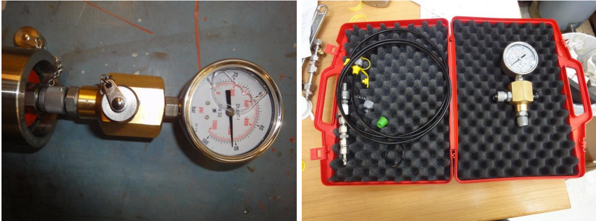
Figur A-16 Fylling av pulseringsdemper med nitrogen til 80 bar med fyllesettet bestilt fra Flow-Teknikk AS
