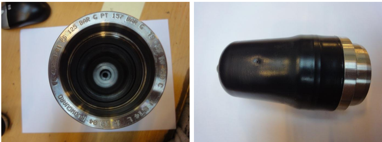
Figur A-15 Pulseringsdemper. F.V.: Metallhuset og belg med rift
