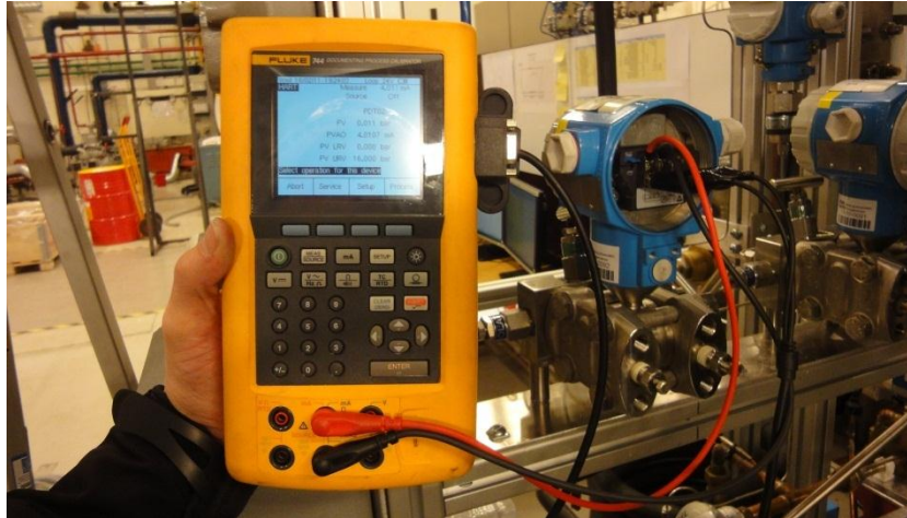
Figur A-11 Kalibrering av Endress & Hauser DELTABAR S trykkmålere med FLUKE 744
