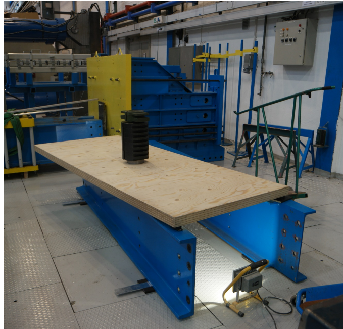
Figur 3.6 Oversiktsbilete for deformasjonsmålingar med last.
