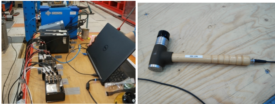
Figur 2.12 Oppsett av OROS-systemet og modal hammar.
