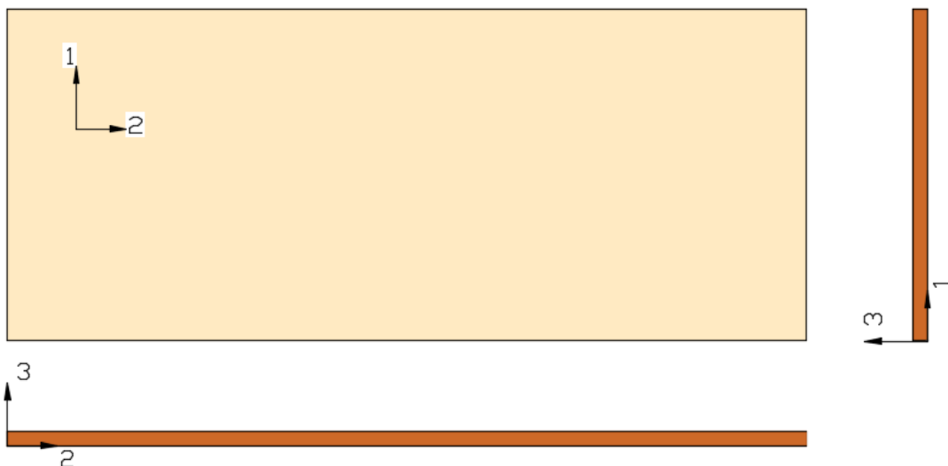
Figur 3.1 Kerto-Q plate med akseretningar.
