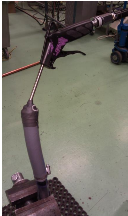
Figur 3.33: Metoden for fylling av olje i lederkanalen.
