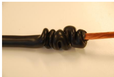
Figur 3.31: Deformert kabelisolasjon etter mislykket forsøk på å trekke ut lederen i en 3 m lang kabel.
