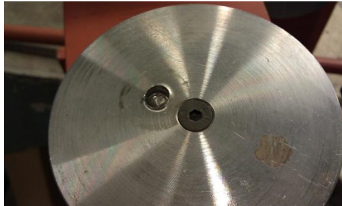
Figur 3.16: Skade på drivhjulet fra eksenterbolten
