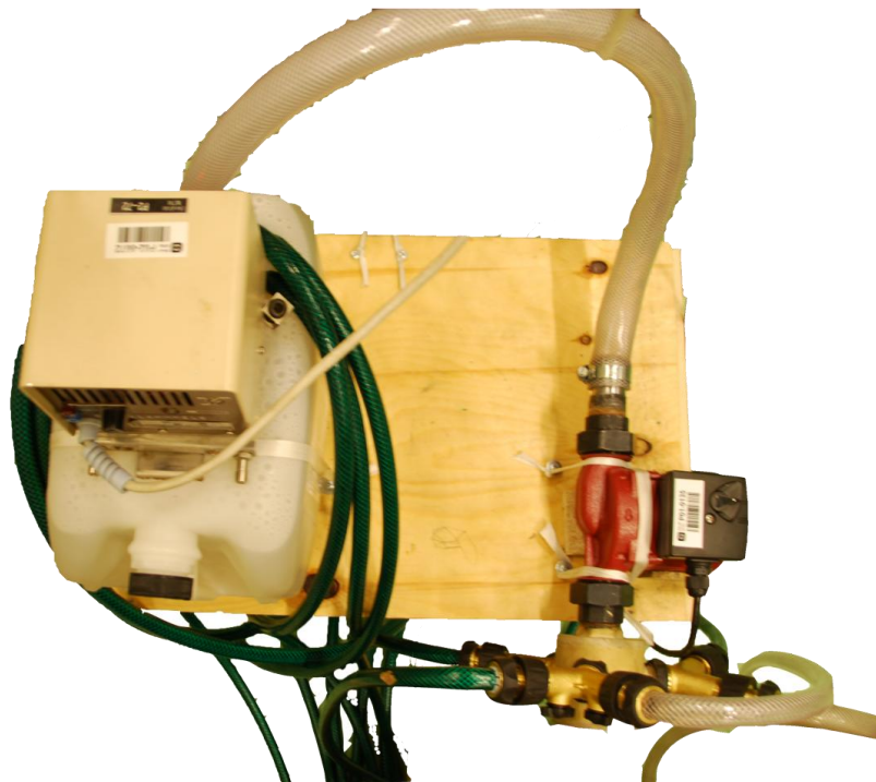
Figur 3.41: Vannfordelingssystemet, vanntank og varmeelement til venstre, og pumpe og vannfordeler til høyre.
