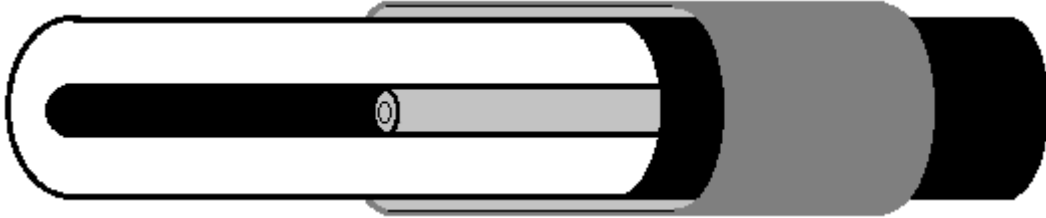
Figur 3.36: Festepunkt med rustfritt rør i lederkanalen.
