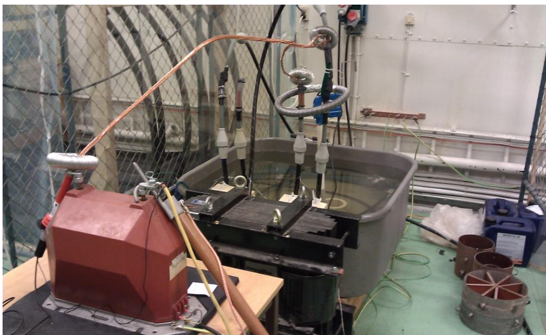
Figur 3.10: Apparaturen som ble brukt i eksperimentet med statisk mekanisk belastning av kabler.
