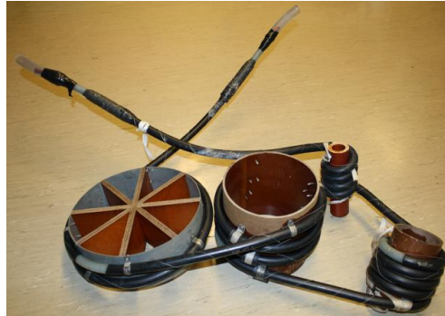
Figur 3.3: En kabel bøyd rundt rør med fire forskjellige diametre.
