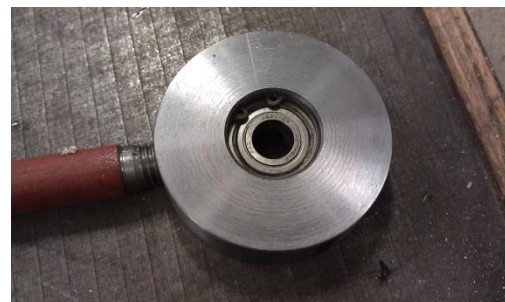
Figur 3.17: a) Den originale løsningen med eksenterbolt og stag. b) Ny løsning med kulelager.
