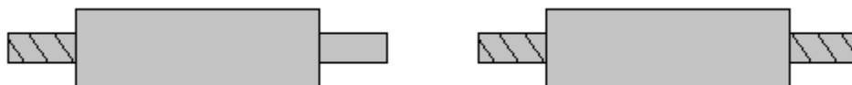
Figur 3.19: Skisse av eksenterbolt til Motor 1 til venstre og til Motor 2 til høyre.
