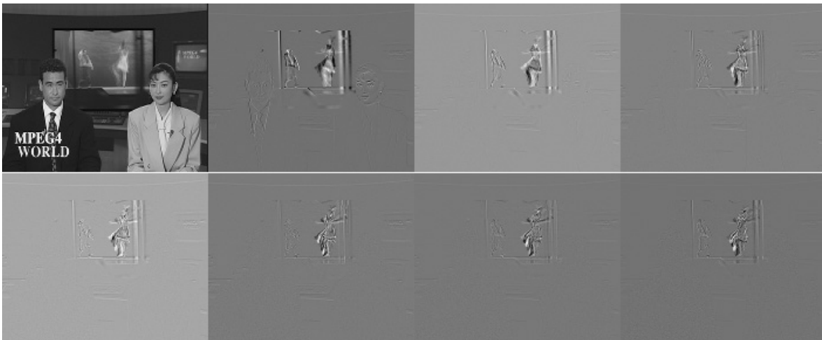
Figur 4.2: Skalert versjon av utgangssignalet fra den temporale dekomposisjonen (ved bufferstørrelse 8). Hver ramme er skalert uavhengig av de andre rammene, for at verdiene i rammen skal være tilpasset intervallet [0 \ 255] .
