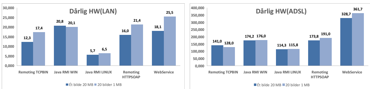
Figur 8.6: Sammenligning av bildeoverføringer ved dårlig hardware
