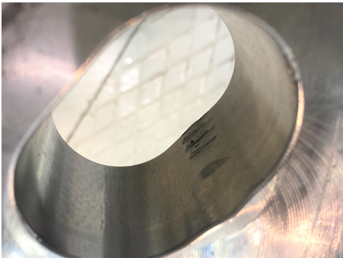
Figure 6.4: Merker etter forspenningsbolt i gaffel-profil
