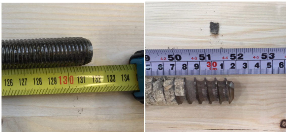
(a) Lengde på gjengestang før montering
