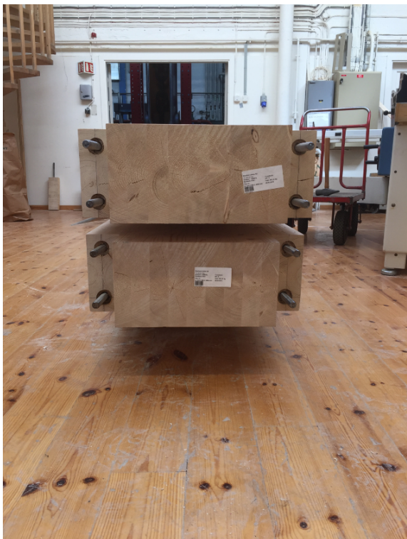
(c) Gjengestenger ferdig montert
