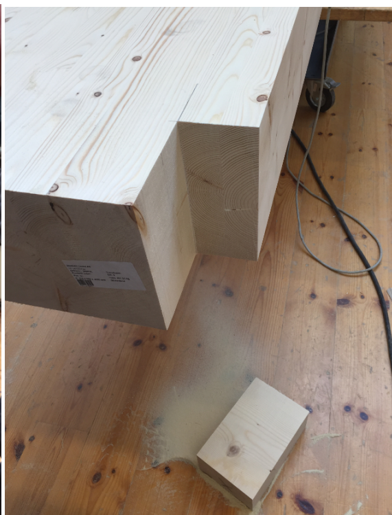
(d) Ferdig innsnitt
