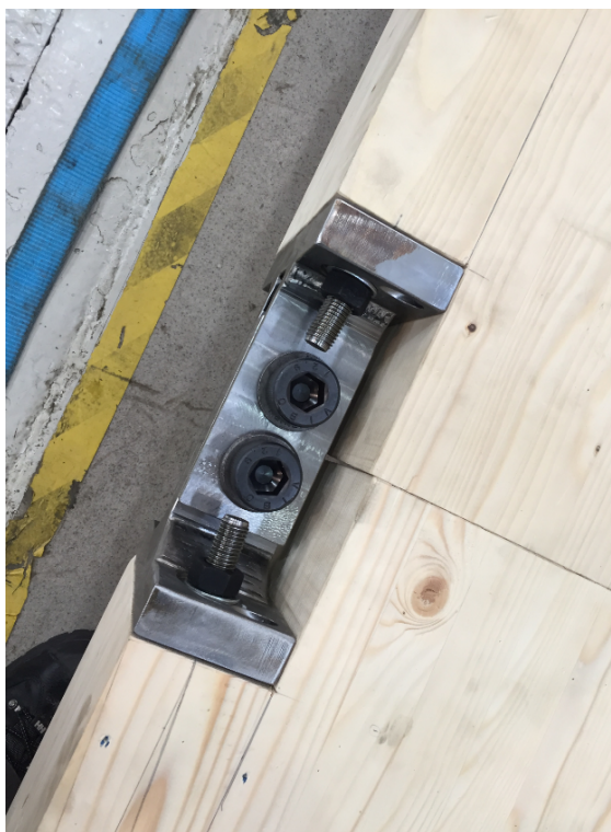
(d) Prøvemontering med M30 bolter
