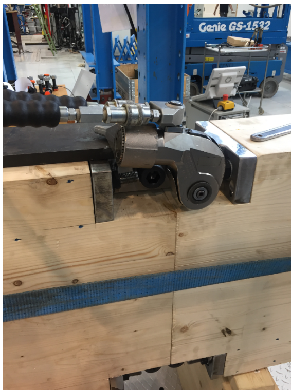
(c) Forspenning med momenttrekker
