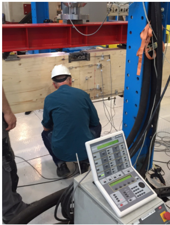
(b) Kontroll av deformasjonsmålere
