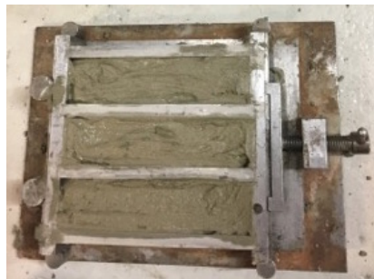
Figur 5.11: Prismeformer fylt med mørtel
