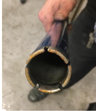
Figur 5.4: Diamantbor for kjerneboring
