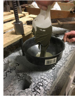
Figur 5.12: Gysing av borehull
