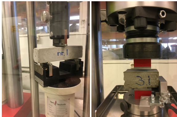
Figur 5.17: Bøye-, og trykktestemaskin på NTNU
