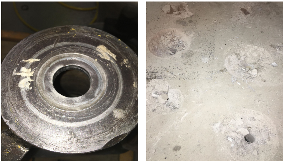
Figur H.1: Pidestalen og konusbrudd i avrettningssmassen etter forsøk
