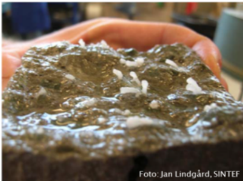
Figur 2.1: Alkaligel i en betongprøve [38]
