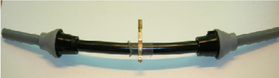
Figur 7-8: Bilde av testoppsett med en 12 kV kabel med en nål
