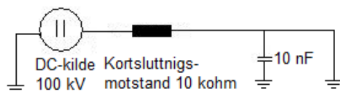
Figur 4-2: Kretsskjema for DC-siden etter gjennomslag
