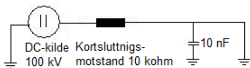
Figur 4-2: Kretsskjema for DC-siden etter gjennomslag
