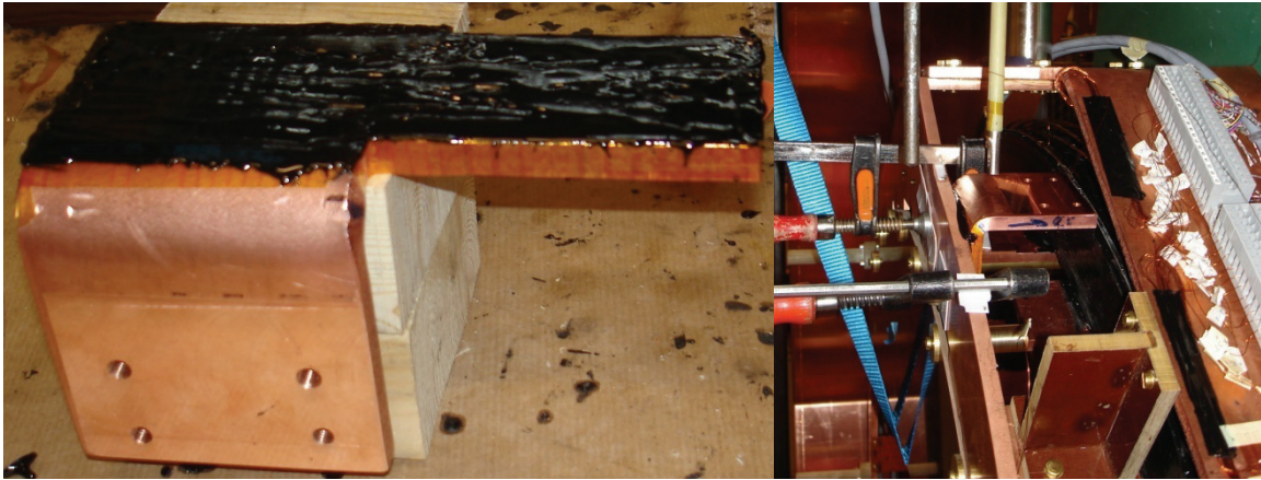
Figur 3-22 Del to med påført et lag kaptontape og epoksy (venstre) og under montering (høyre)
