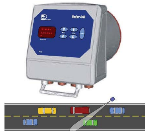
Figur 4.4: Eksempel på måleutstyr for trafikk tetthet og hastighet med virkemåte [5]
