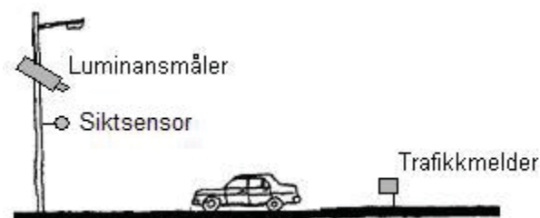
Figur 4.12: Oversikt over systemkomponenter [5]
