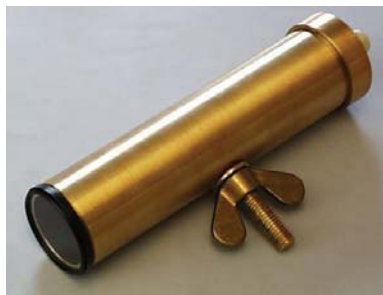
Figur 4.10: Tidlig versjon av luminansmetret utviklet av Sintef IKT Fotonikk [5]
