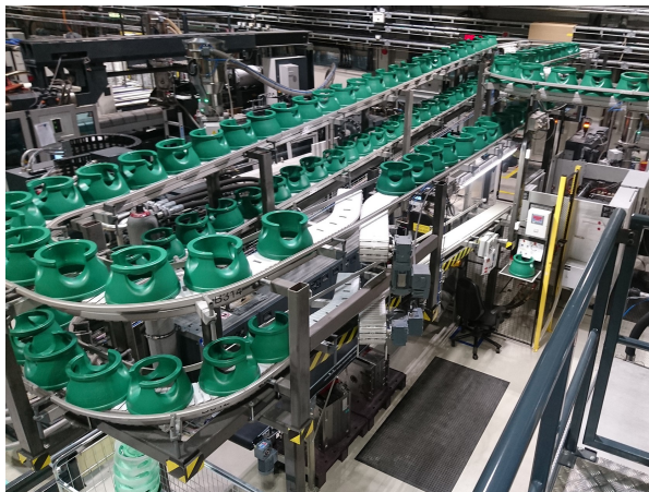
(a) Det er en bufferbane for hver presse som har omtrent samme form og lengde
