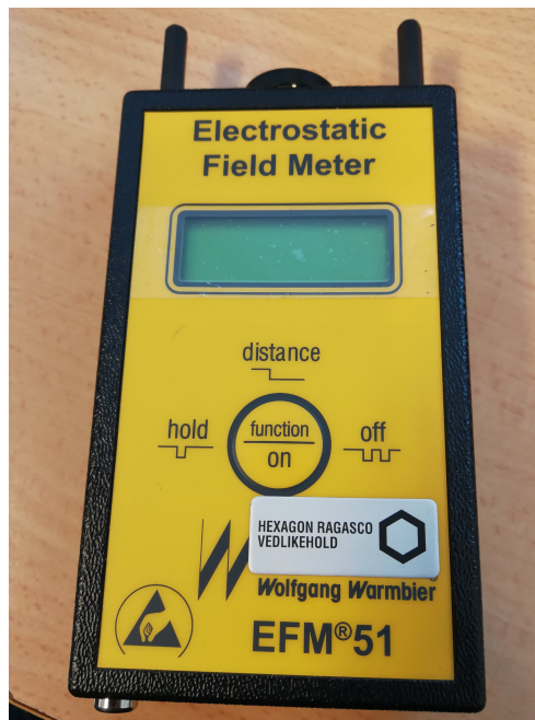
Figur 2.2: Målinger av elektrostatisk felt er gjort med feltmeteret EFM51.
