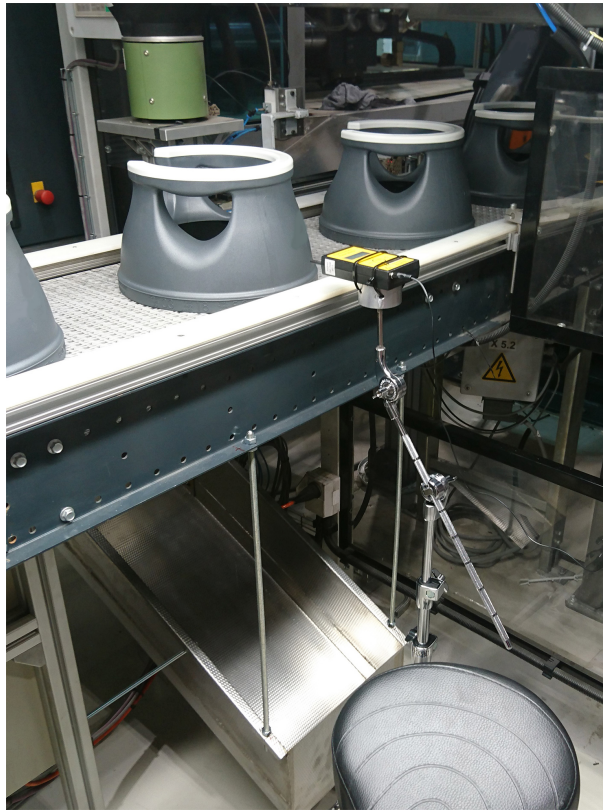
Figur 5.13: Oppsett ved målinger på topphatt direkte etter produksjon
