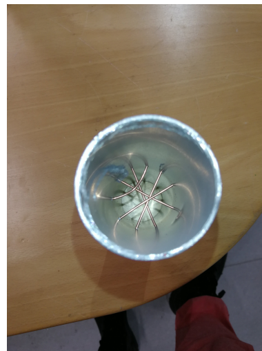
(b) Måleprobe 2 var et aluminiumsrør med et gitter av kobberledere gjennom sentrum av røret.
