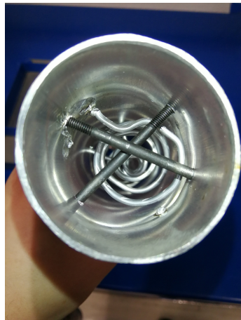
(a) Måleprobe 7 lik utforming som måleprobe 6 bortsett fra at spiralene ble festet i begge ender og det ble montert en sikring i enden i form av to bolter i kryss.
