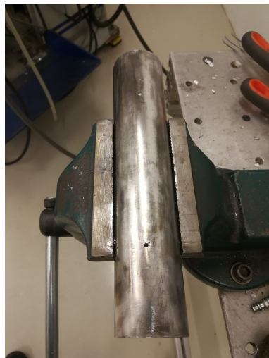
(a) Måleprobe 1 var et rent aluminiumsrør lik den på bildet over.
