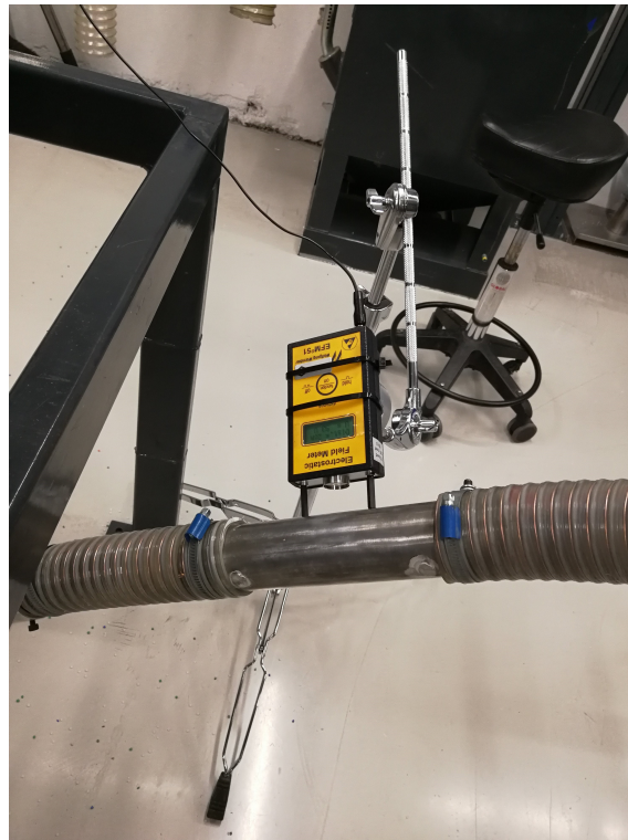
Figur 4.2: Måleoppsett for målinger på materialmiks som passerer gjennom måleprobe som er montert på rørsystem fra mikser til presse.
