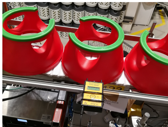
(b) Oppsett av instrument ved målepunktet
