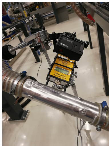
(a) Oppsett av målinger på måleprobe med video-opptak vha. GoPro-kamera.
