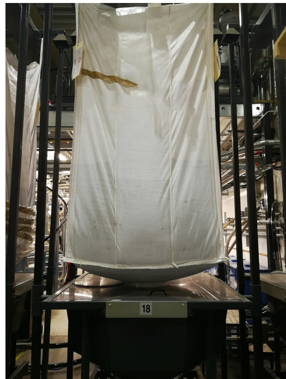
(b) Masterbatch lagres i større plastsekker hengende over containere tilkoblet rørsystem for farger som er mye brukt.
