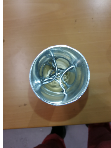
(b) Måleprobe 6 hadde flere aluminiumsledere sveist i en formasjon som etterlignet en spiral gjennom hele lengden av aluminiumsrøret.
