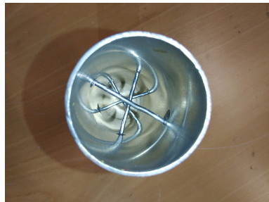
(a) Måleprobe 3 var et aluminiumsrør med sveiste aluminiumsledere gjennom røret innvendig spredt over lengden av røret.
