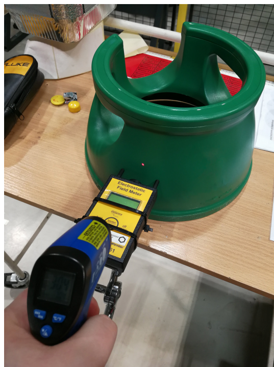
Figur 5.3: Oppsett ved måling av utladning på topphatt
