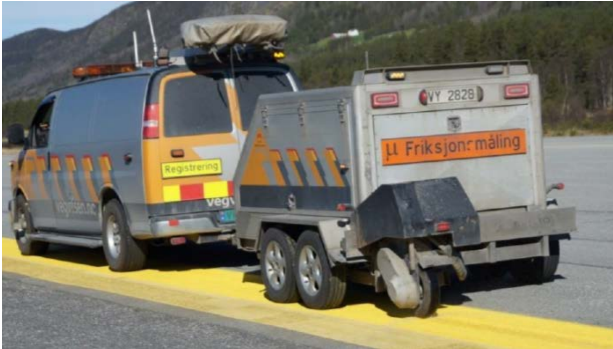
Bilde 2.1 Måling av friksjon ved slippmåler (Dahlen, 2015)
