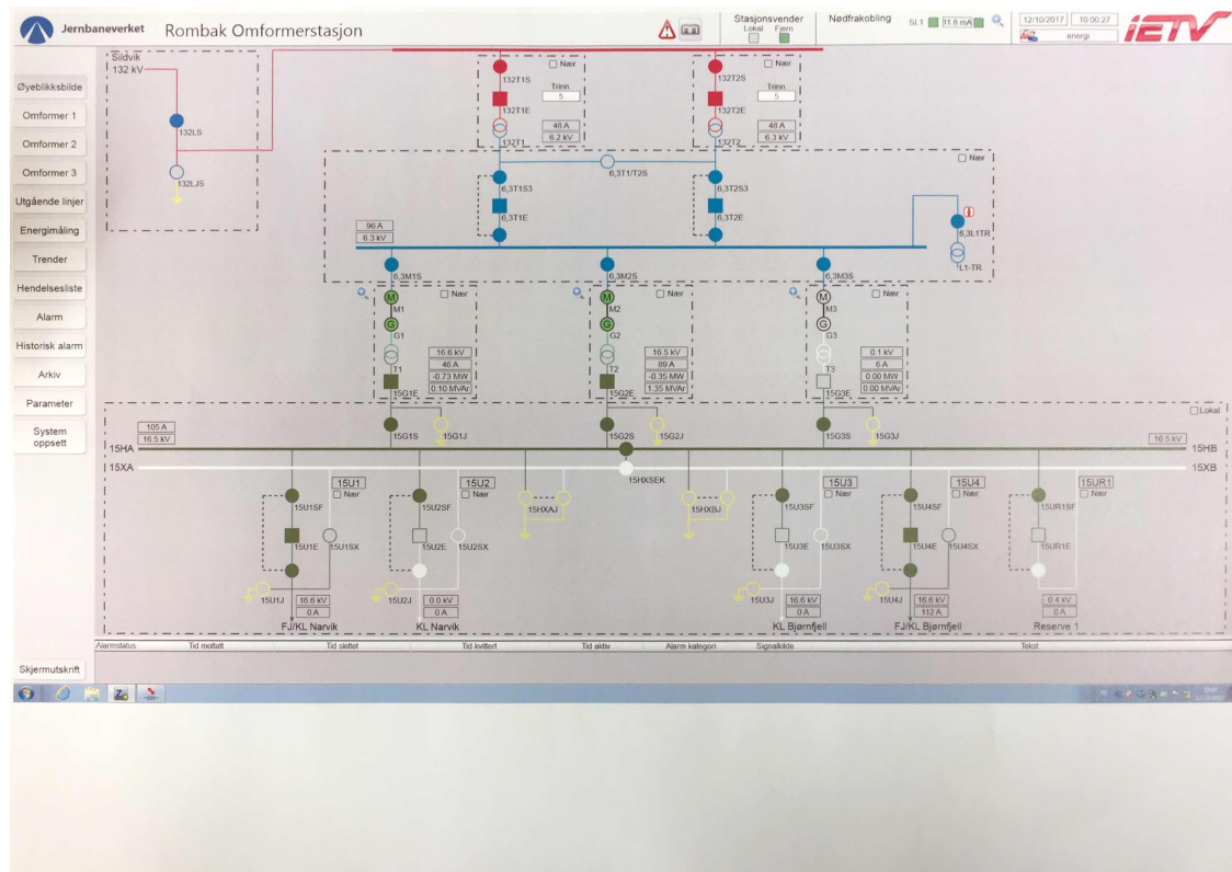
Figur 6: Koblingsbilde Rombak omformerstasjon[11]
