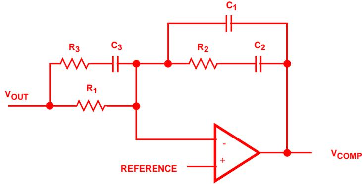
$$GAIN_{TYPEIII} = \frac{R_1 + R_3}{R_1 \cdot R_3 \cdot C_1} \cdot \frac{\left(s + \frac{1}{R_2 \cdot C_2}\right) \cdot \left(s + \frac{1}{(R_1 + R_3) \cdot C_3}\right)}{s \cdot \left(s + \frac{C_1 + C_2}{R_2 \cdot C_1 \cdot C_2}\right) \cdot \left(s + \frac{1}{R_3 \cdot C_3}\right)}$$
