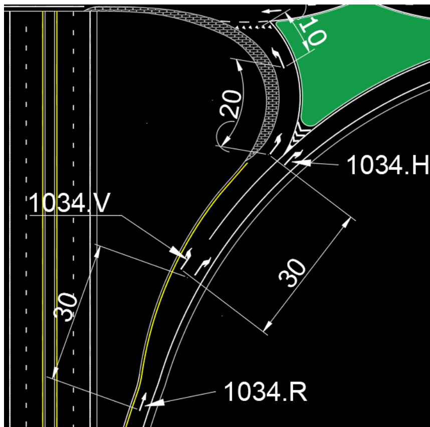
Figur 7.3.12: Symboloppmerking på avkjøringsrampen
