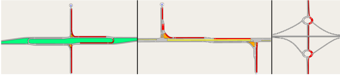
Figur 6.5.5: Gjennomkjøring på sideveg for de ulike kryssene
