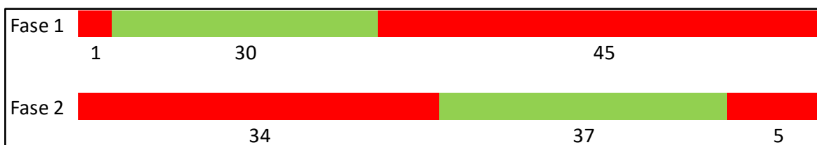
Figur 7.5.15: Faseplan for trafikkbelastning «høy»
