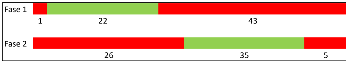
Figur 7.5.16: Faseplan for trafikkbelastning «høy avsving»
