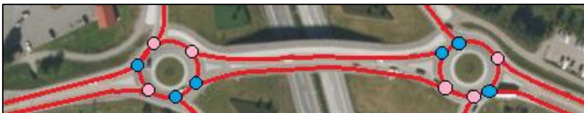
Figur 7.6.3: Konfliktpunkter i ruterkryss regulert av rundkjøringer
