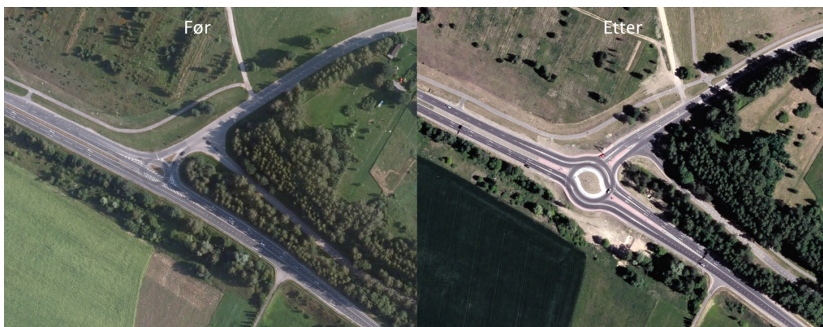
FIGUR 4. FØR OG ETTER SITUASJON. TURBORUNDKJØRING I BIRŠTONAS (B) (2015). (KILDE: WWW.GEOPORTAL.LT OG WWW.MAPS.GOOGLE.LT )
