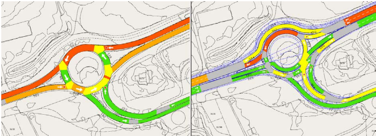
FIGUR 76. RESULTAT FOR TRAFIKKFLYT VED ENDRING I FASEPLAN. EKSISTERENDE RUNDKJØRING (VENSTRE) OG TURBORUNDKJØRINGEN.
