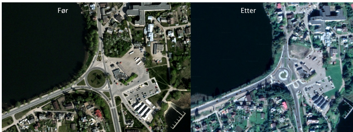
FIGUR 9. FØR OG ETTER SITUASJON. TURBORUNDKJØRING I TRAKAI (C). (KILDE: WWW.GEOPORTAL.LT OG WWW.MAPS.GOOGLE.LT )
