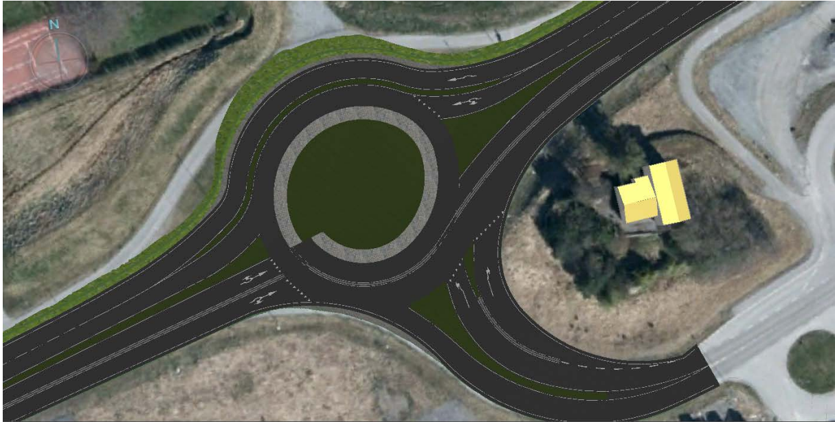
FIGUR 56. TURBORUNDKJØRING. YTRE RADIUS ER CA R=28,5\text{M}
