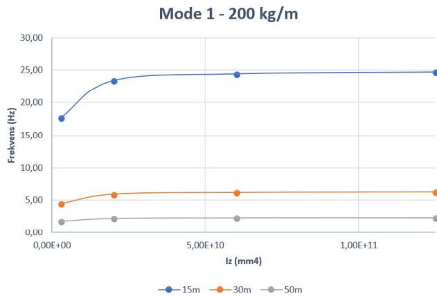
Figur 4.28: Effekten av stivhetsøkning for forskjellige spenn
