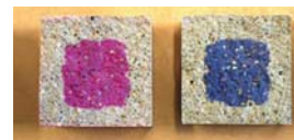
Sammenligning av 1 prosent fenolftalein løsning (venstre) og 1 prosent tymolftalein løsning (høyre) som pH indikator sprayet på en fersk splittet overflate av karbonatisert mørtel. Farget mørtel angir ukarbonatisert område. Foto: NTNU
