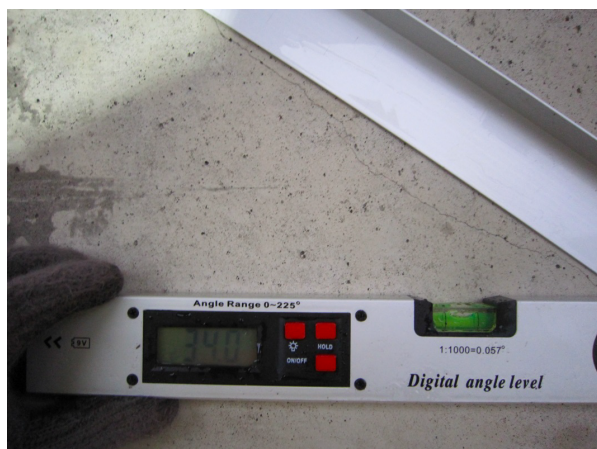
Figur 5.10: Skrårissvinkel midt i hovedspenn på 30^\circ
