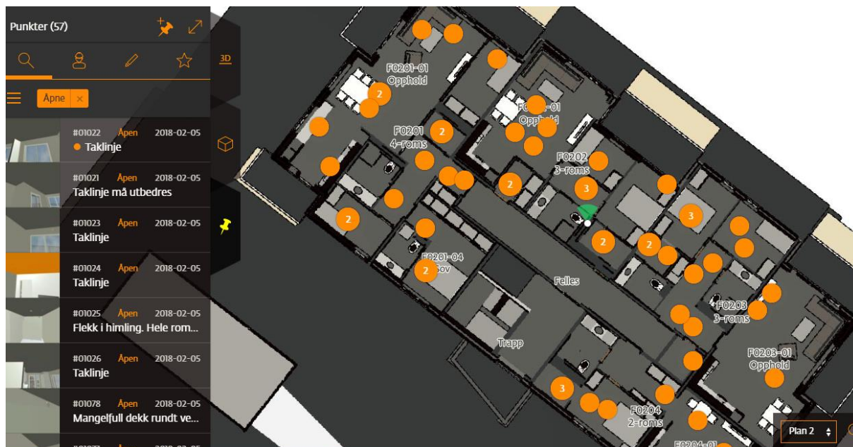
Figur 11: Utbedringer - utbedringer registrert digitalt
