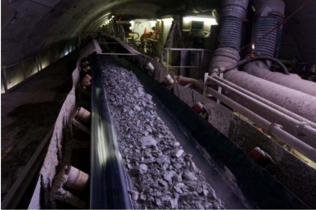
Figur 44. Transportbånd med tunnelmasser fra en TBM som er plassert opp mot taket (Beitnes, 2016).
