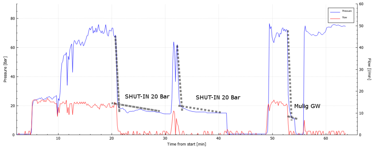
Figur 9.6: Tolkning av shut-in -trykk ved en strømningsstans på hull 38 m/ mulig tolkning av grunnvannstrykk.
