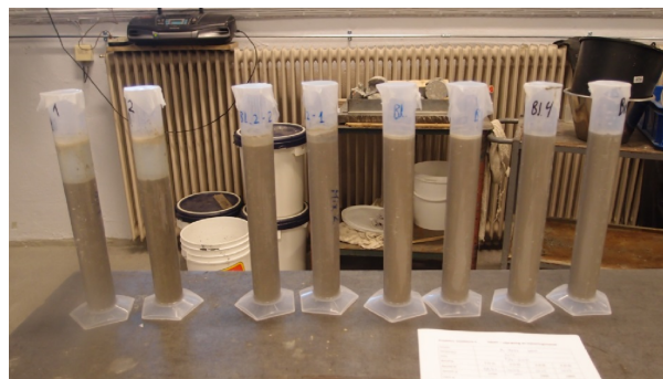
Figur 3.7: Bleedingtest. Fra Skjølvold m.fl. [33].
