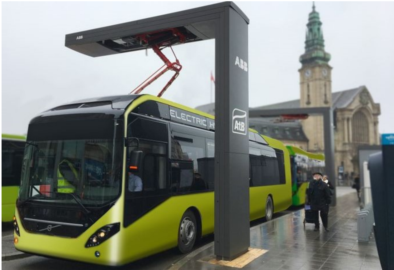
Figur 2.18: Illustrasjon av lading av elbuss via pantograf, AtB[14]
