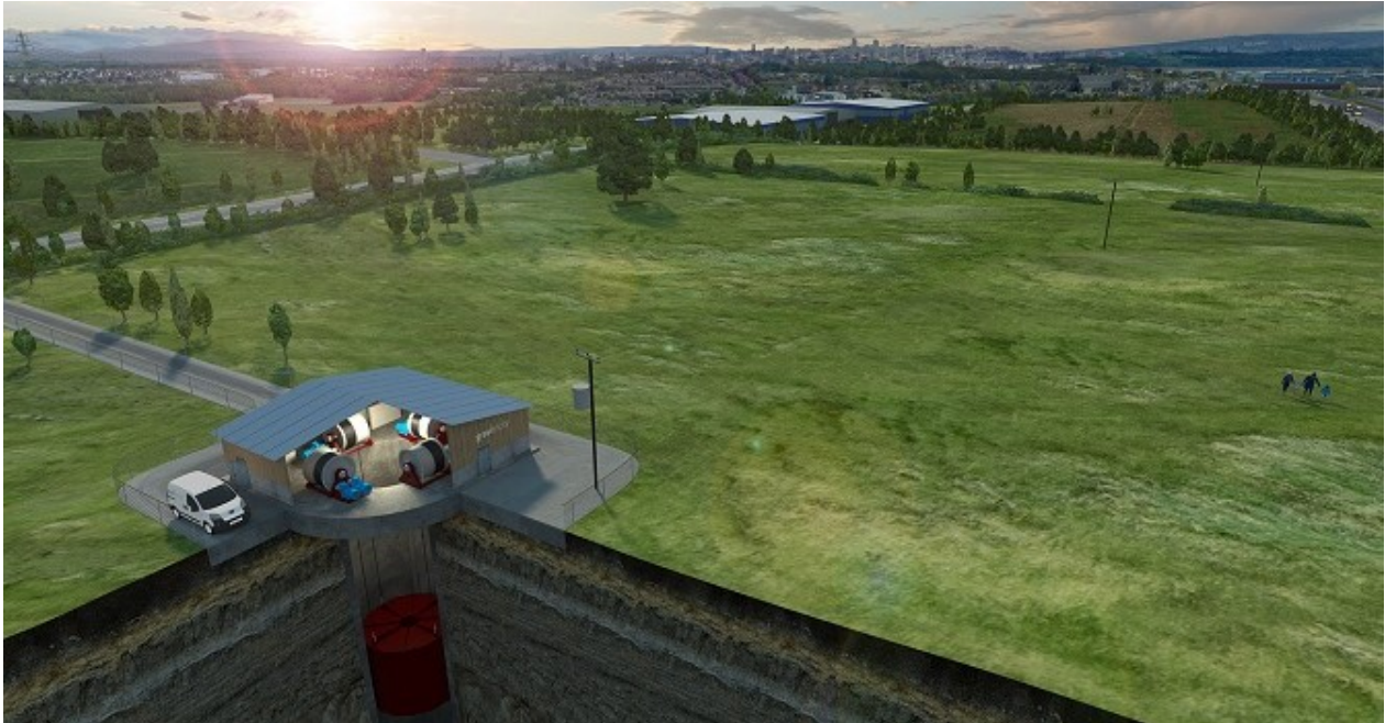
Figur 2.12: Illustrasjon av langringing av energi som potensiell energi, gravitricity[9]
