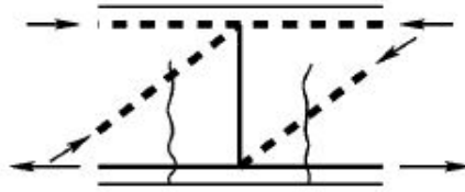
Figur 10.2: Stavmodell for skjærarmring der stiplede linje representerer trykkstaver og heltrukne linje representerer skjærarmring [15]
