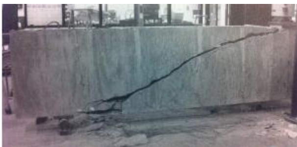
Figur 3-2 Fotografi av diagonalt strekkbrudd [19]
