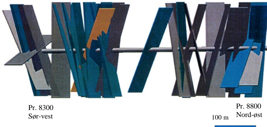
Figur 4.6: 3D-representasjon av sprekkegeometrien i Puttjernsonen. Den horisontale sylindere representerer Romeriksporten. Blå plan markerer sterkt vannførende sprekker, mens det brune planet illustrerer Puttjernforkastningen. Puttjernforkastningen skjærer tunnelen med et fall på 60°. Modifisert etter Kitterød et al. (1998).
