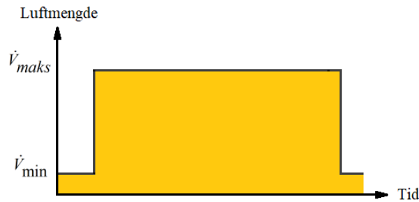
Figur 3.1: Typisk luftmengdeforløp med CAV-styring. Utarbeidet fra exhausto.no [21]
