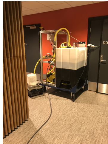
(d) Pumps and flow measurement
