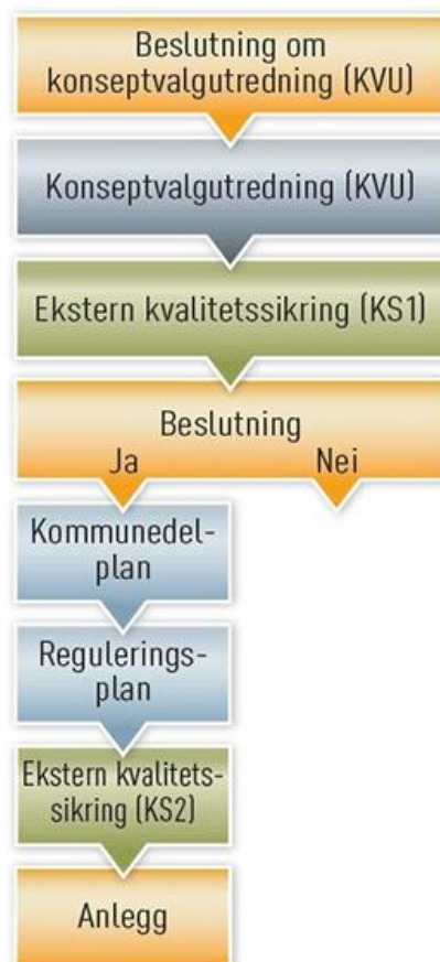
Figur 2 Planprosess for riksvegprosjekter (Statens vegvesen, 2018)
