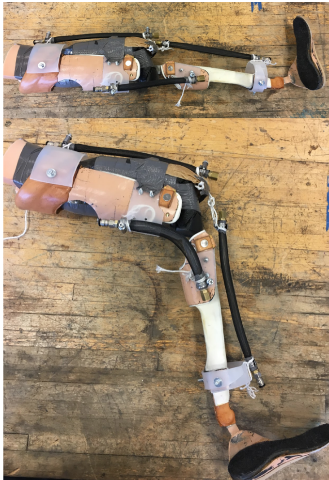
Figur 6.1: Funksjonell prototype av konseptet i ekstensjon og fleksjon.
