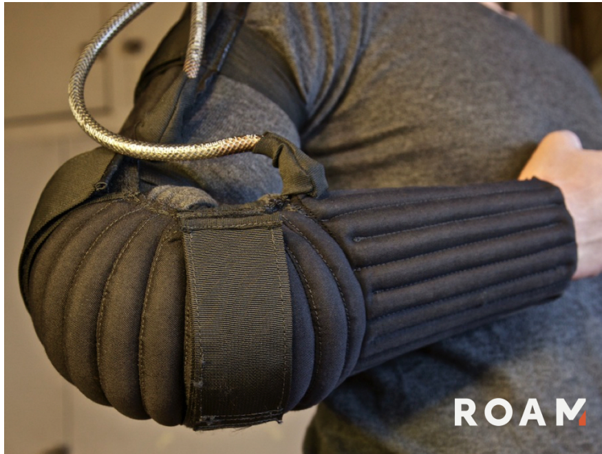
Figur 3.12: Roam robotikk sin tidlige prototype av et konsept basert på LM [13].
