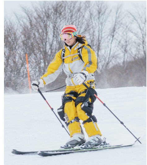
Figur 8.5: Roam Robotic sitt eksoskjelett basert på lufttrykk for skikjøring [12].
