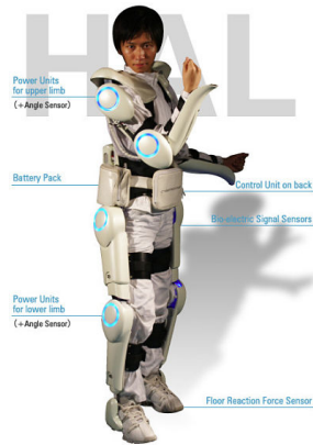
Figur 5.16: HAL benytter seg av en rekke sensorer, og kan gi styrke til overkroppen også [43].
