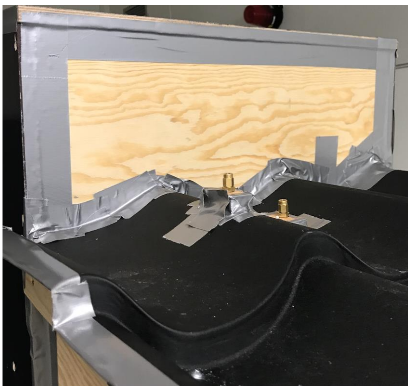
Figur 4.20 Teipet overgang Ambassador mot møneke
