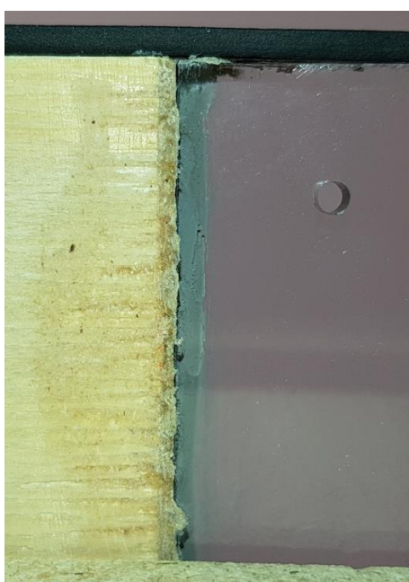
Figur 3.14 Sparklet overgang mellom lexan og Takboks 2 (Hull til røyk i vinduet)
