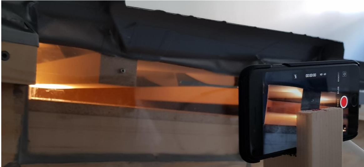
Figur 4.22 Kameraoppsett for filming av røykforsøk
