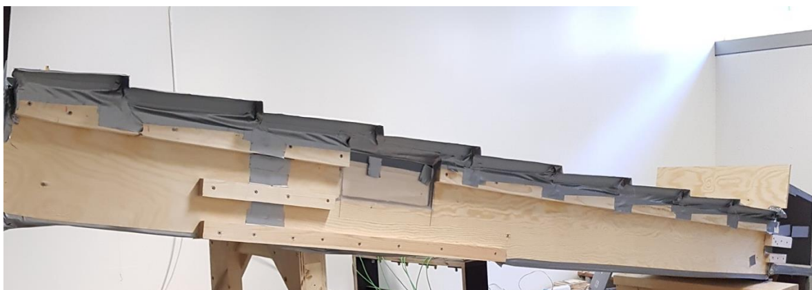
Figur 4.21 Teipet overgang takplate (Ambassador) mot Takboks 2
