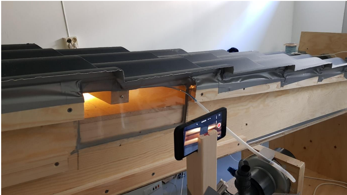
Figur 1: Luftstrømmens forløp under taktekningen er filmet ved hjelp av røyk og spesiell lyssetting. Foto: Olaf Rør.
