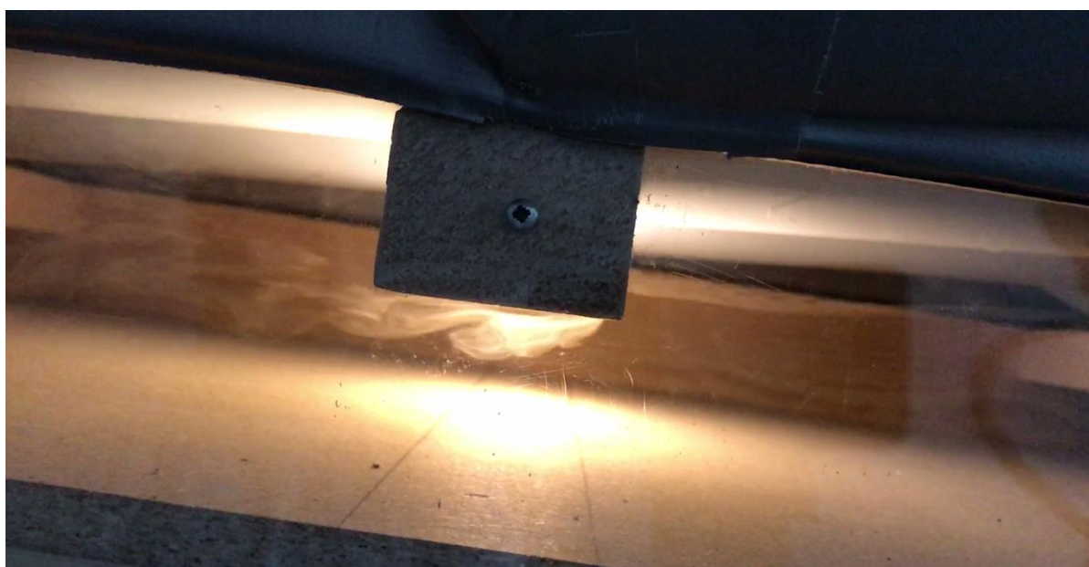
Figur 5.24 Rettkantet 36 x 48 mm, 48 mm sløyfehøyde, 0,2 m/s
